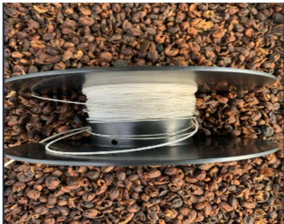
*Nota.* Producto final. Rollo de filamento extruido a partir del polímero PLA Ácido Poliláctico sintetizado el laboratorio a partir de los desechos del aserrín de bambú.
