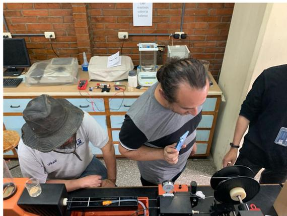
*Nota.* Extrusor puesto en marcha. Extrusión del polímero sintetizado (fabricación del filamento de impresión 3D de PLA).
