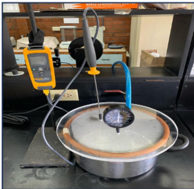
*Nota.* Sistema de vacío, en el que realizaron pruebas de polimerización.
