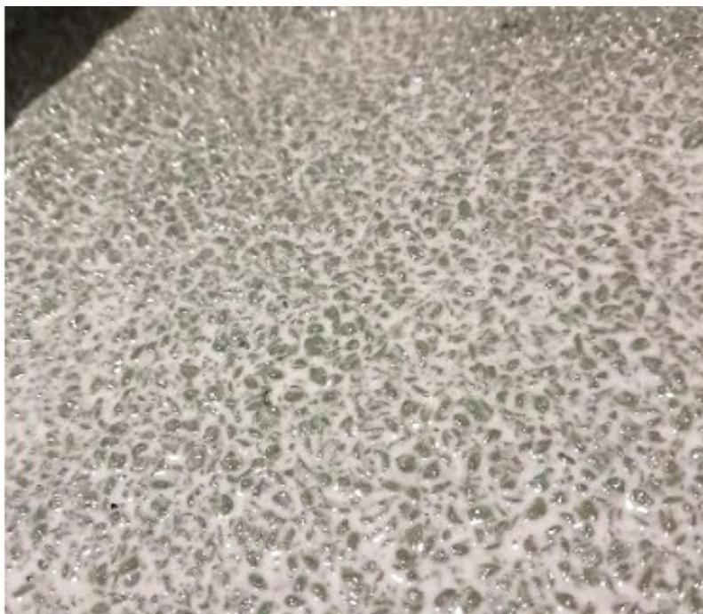
Nota. Vista de un tablero de densidad media con 60% de resina y 40% de PVC peletizado.
