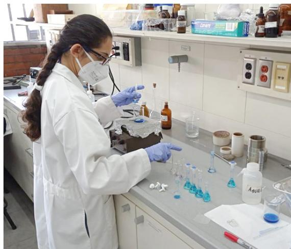
Nota. Preparación de las disoluciones obtenidas de los experimentos de adsorción con azul de metileno por la auxiliar de investigación 1.
