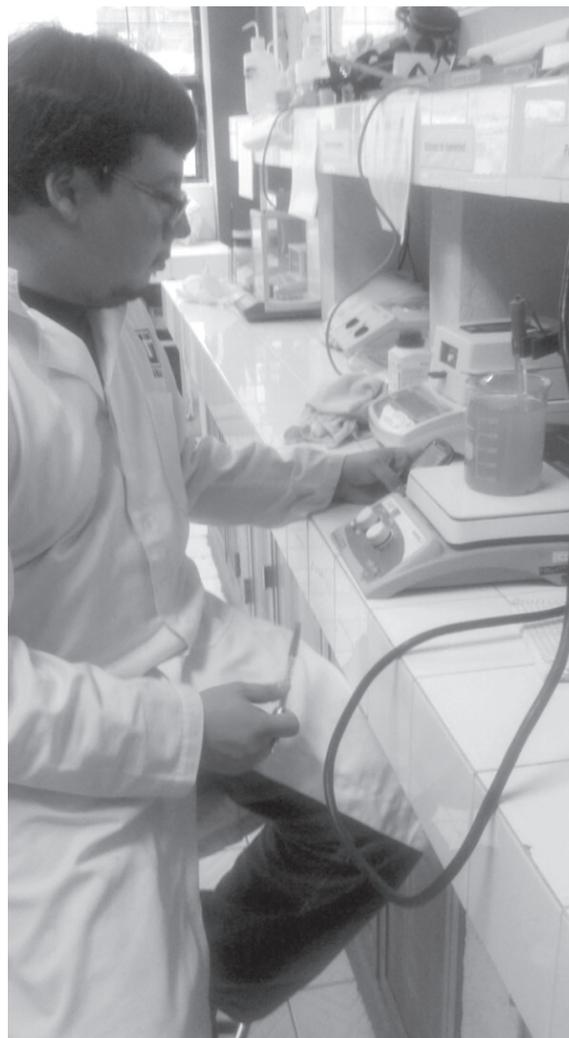
*Nota.* Prueba preliminar del proceso de separación. Se está agitando la solución a tratar para realizar la reducción de los metales pesados.
