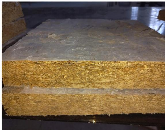
Nota. Vista lateral de los tableros de virutas orientadas fabricados con residuos de laminado de bambú.
