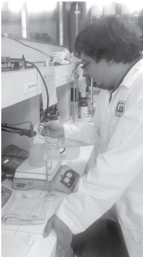
*Nota.* Prueba preliminar del proceso de separación. Se está ajustando el pH de la solución a tratar.
