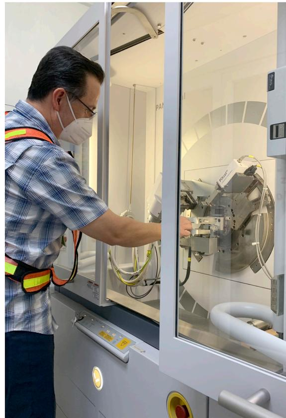
*Nota.* Muestra de arcilla en el equipo de difracción de rayos X.
