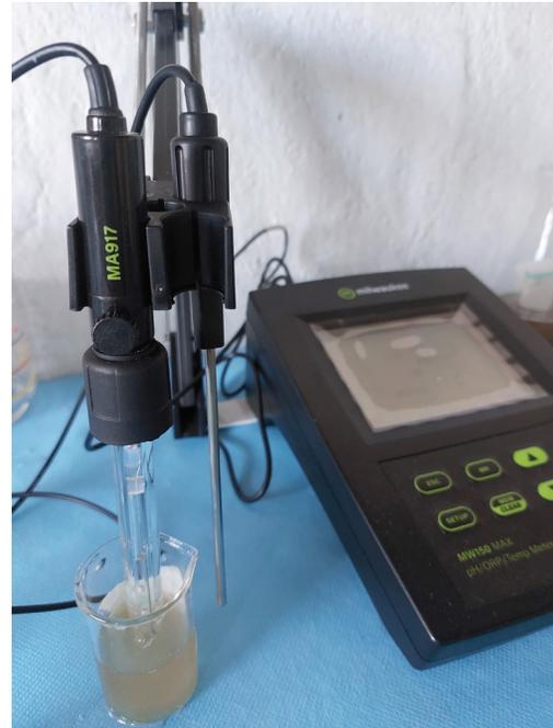
*Nota.* Medición del potencial de hidrógeno del agua residual del café luego de haber sido tratada con carbón vegetal proveniente del residuo sólido de la percolación del café.
