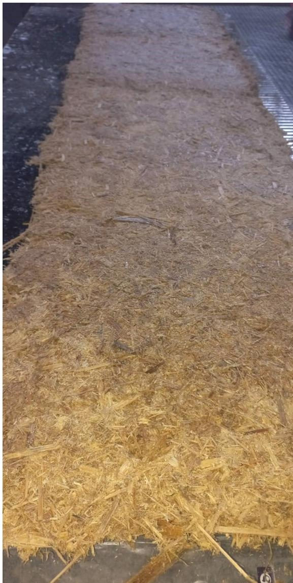
Nota. Tablero de virutas orientadas de bambú (*Dendrocalamos Asper*) de un pie por 4 pies con un grosor de ½ pulgada.
