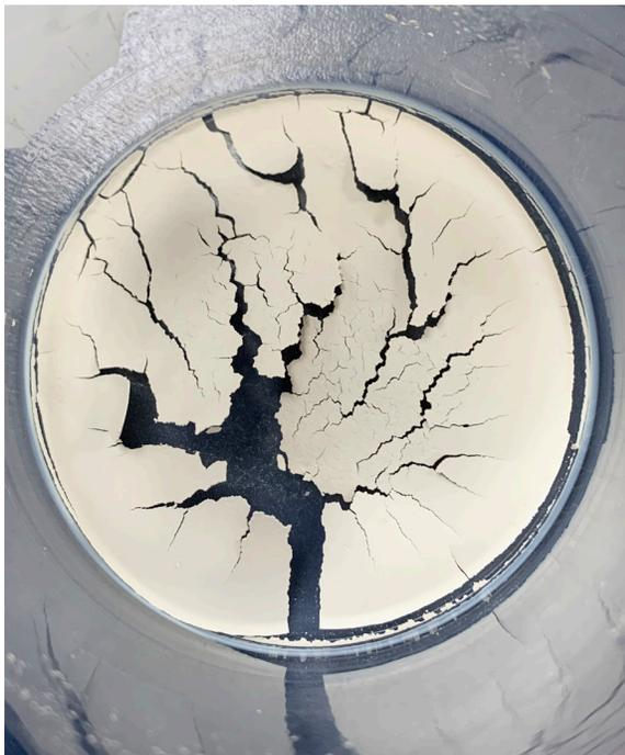
*Nota.* Muestra de arcilla funcionalizada que se somete a secado para posteriormente saturarla con fósforo y evaluar la capacidad de captura de fósforo.
