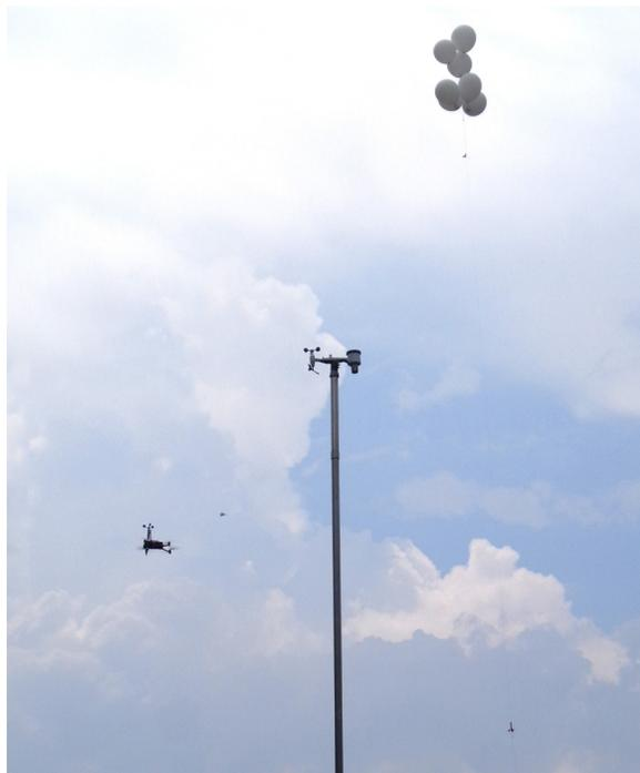
*Nota.* Los tres sistemas de monitoreo eólico en funcionamiento: por mástil, elevado por globos inflados con helio y elevado por dron, en cada uno se integró un anemómetro para la medición de la velocidad del viento.
