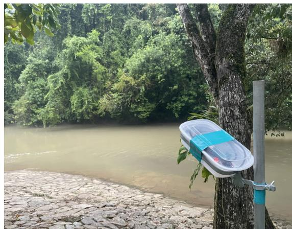
*Nota.* Disposición a orillas del río Lanquín de uno de los micrófono Ultramic 384K BLM dentro de un recipiente protector.
