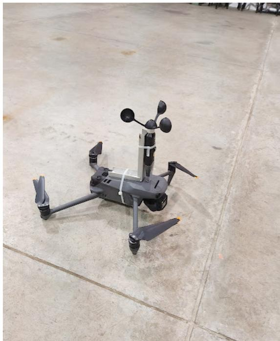
*Nota.* Sistema por elevación con dron ensamblado, el anemómetro se montó sobre el dron por medio de una base ligera de aluminio.
