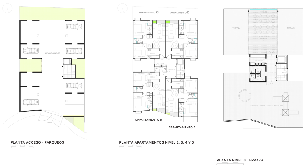
Figura 98. Plantas arquitectónicas que ilustran la estructura sin columnas, ya que se adoptó el sistema de muros de concreto con baja ductilidad, de sección constante.
