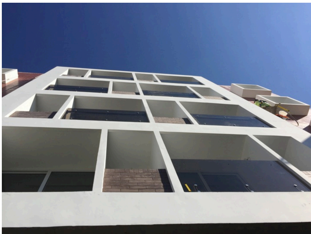
Figura 99. Vista de la fachada sur, los balcones fueron trabajados como parteluces que controlan la incidencia solar.
