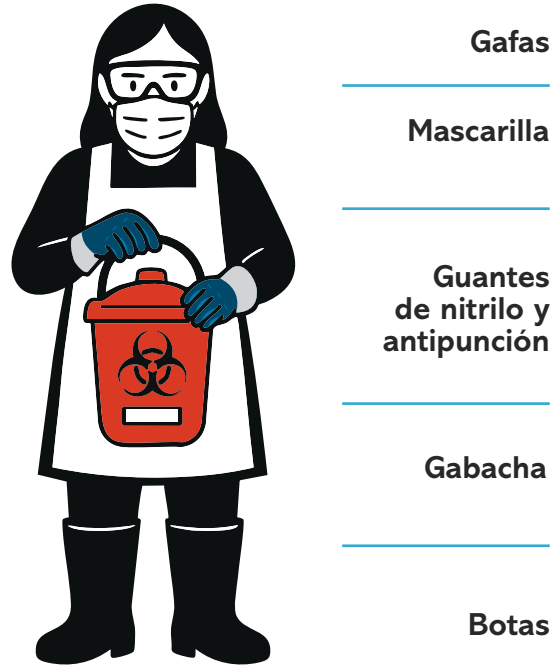
Figura 24: Ilustración de personal con equipo de protección para el manejo de DSH | Crédito: equipo consultor.
