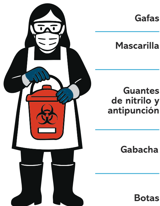
Figura 22: Ilustración de personal con equipo de protección para el manejo de DSH | Crédito: Equipo consultor.
