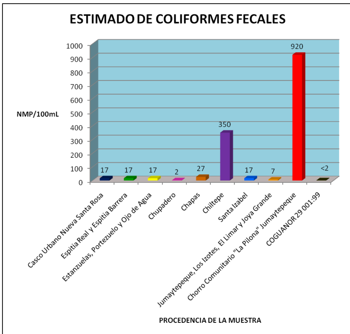
Figura 8. Comportamiento de la presencia del grupo Coliforme fecal en el agua potable de los suministros del municipio de Nueva Santa Rosa, Santa Rosa, según primer muestreo.
