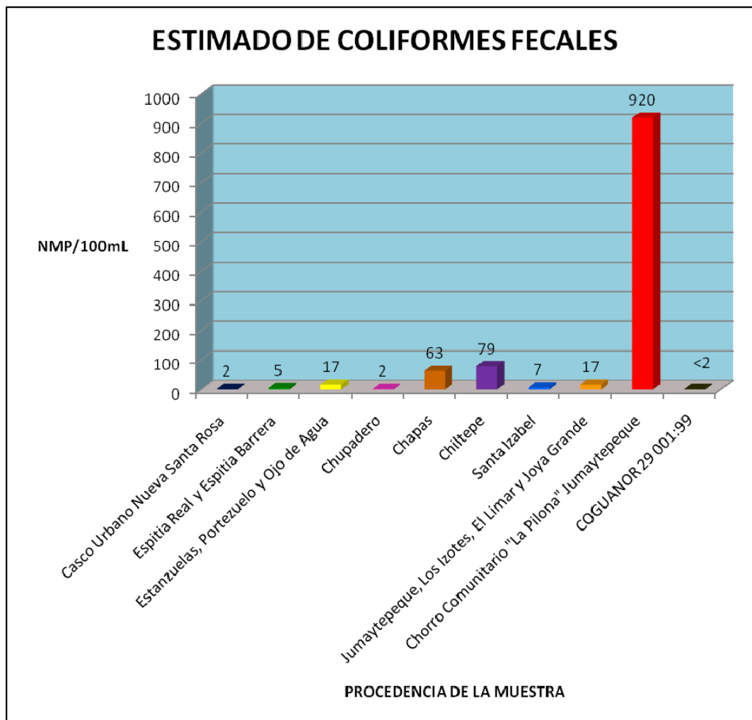
Figura 9. Comportamiento de la presencia del grupo Coliforme fecal en el agua potable de los suministros del municipio de Nueva Santa Rosa, Santa Rosa, según segundo muestreo.
