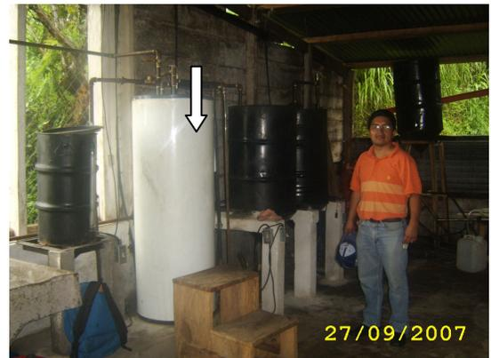
Paso 15: Aquí se hace funcionar una resistencia que calienta el biodiesel a una temperatura de 55 grados provocando con ello evaporación que se observa sobre la superficie del biodiesel dentro de este deposito de secado.
