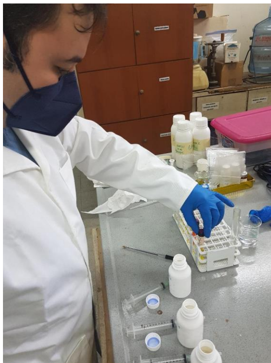
Fotografía No.10, Manuel Muñoz realizando mezcla de reactivos para determinación de cromo total en muestras de agua del río las Vacas.
