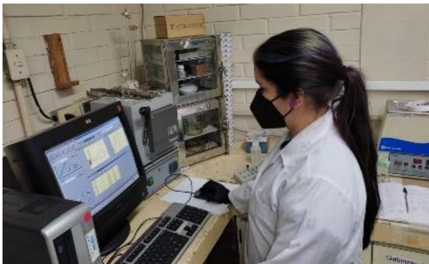
Fotografía No.12, Christa Lemus, elaboración de curva de calibración de orto-fosfatos, mediante espectrofotometría UV/Visible
