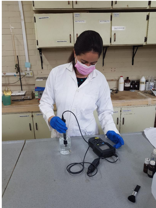
Fotografía No.11, Elisandra Hernández, determinando oxígeno disuelto en muestra de agua colectada en el Río Las Vacas, como parte del análisis de la demanda bioquímica de oxígeno.
