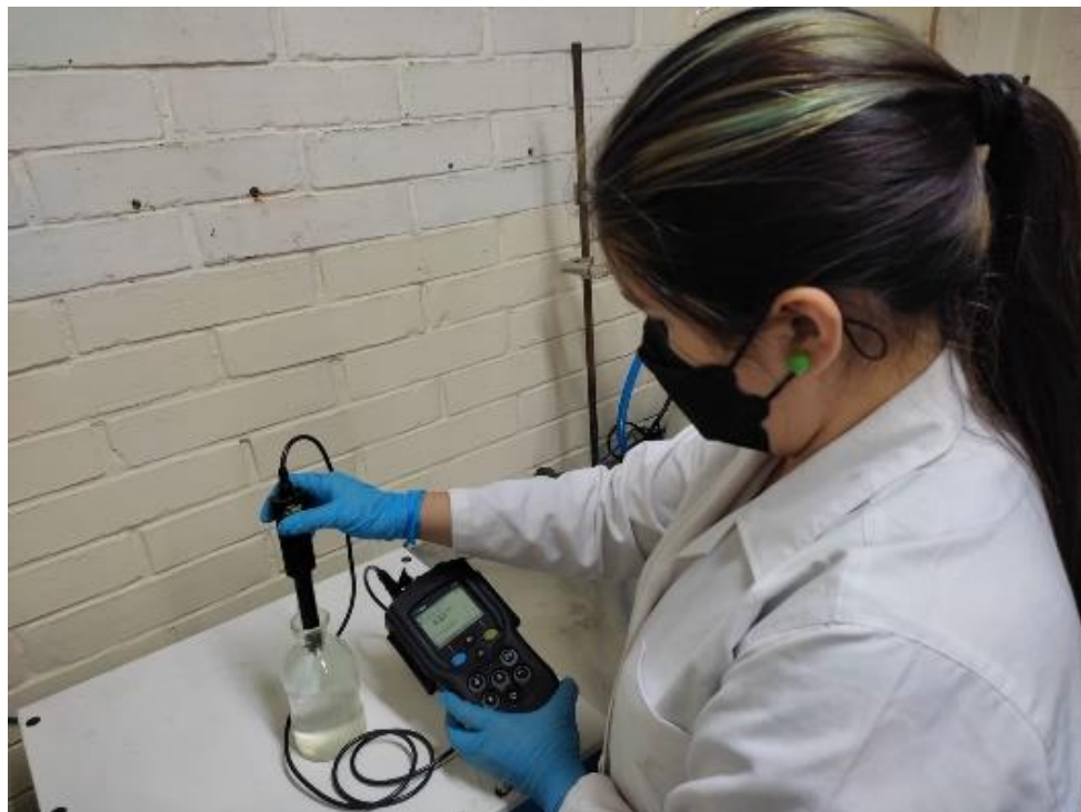
Fotografía No.13, Christa Lemus, determinación de Demanda Bioquímica de Oxígeno, en muestras de agua del Río Las Vacas, colectadas en el muestreo de noviembre 2021.
