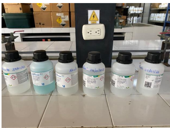
Figura 13.1. Disoluciones patrón utilizadas para la preparación de la disolución del material de referencia (MR).
