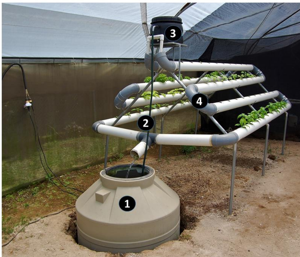
Figura 2. Componentes y funcionamiento de un Módulo Acuapónico NFT en el IICA: Contenedor de agua (1) en cuyo fondo hay una bomba que impulsa el agua a través de una manguera (2) hacia el biofiltro (3); circuitos de tubos PVC (4).
