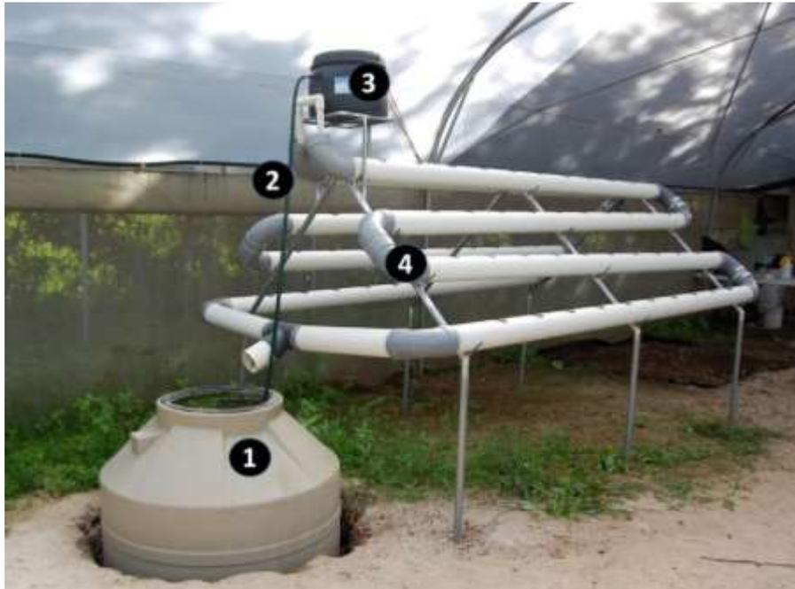
**Figura 1.** Componentes del sistema acuapónico NFT: 1. Tanque tipo tinaco, 2. Manguera plástica, 3. Biofiltro y 4. Circuito de tubos PVC.
