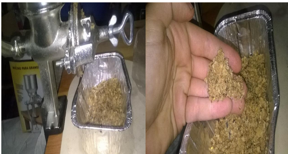
Figura 4. Obtención de harina de semilla de árbol de hule por medio de un molino manual.
