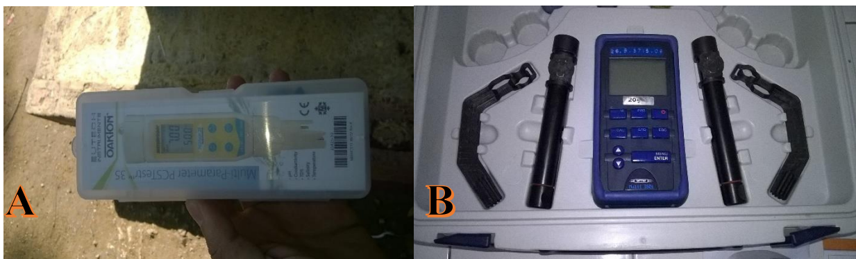
Figura 12. Sondas portátiles utilizadas para medir parámetros de calidad de agua en campo.
