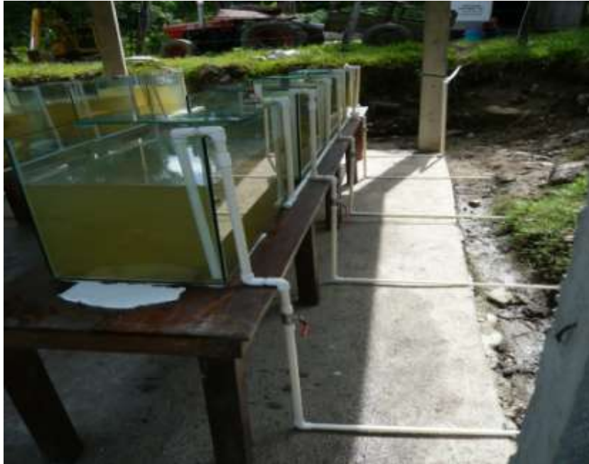
ANEXO. 19. Funcionamiento del desfogue de las peceras.
