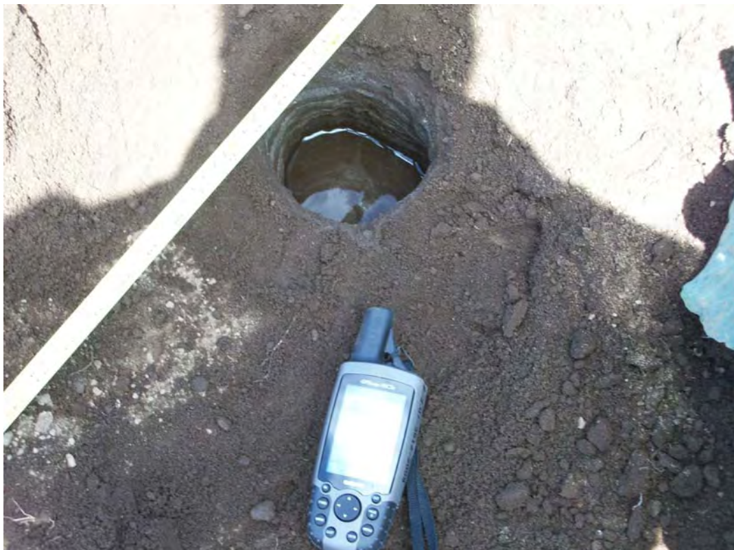
Fotografía 6. Prueba de velocidad de infiltración por medio del método de Porchet
