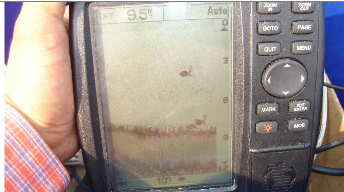
Conteo de peces con el ecosonda durante un crucero de "arrastre virtual".
