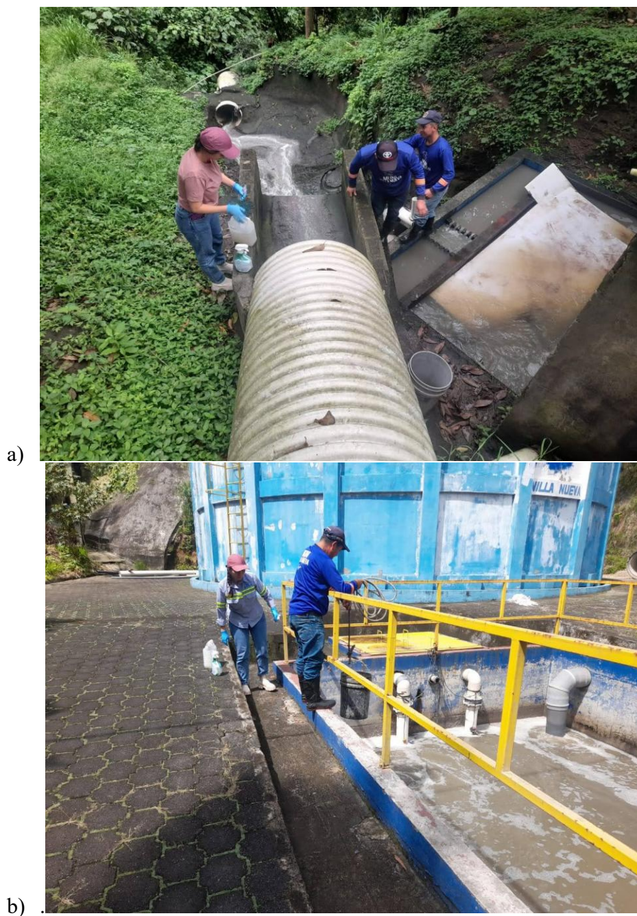
Ilustración IV Extracción de MPS en uno de los 4 puntos de extracción, de una de las 4 plantas estudiadas, con el apoyo de trabajadores de la Municipalidad de Villa Nueva
