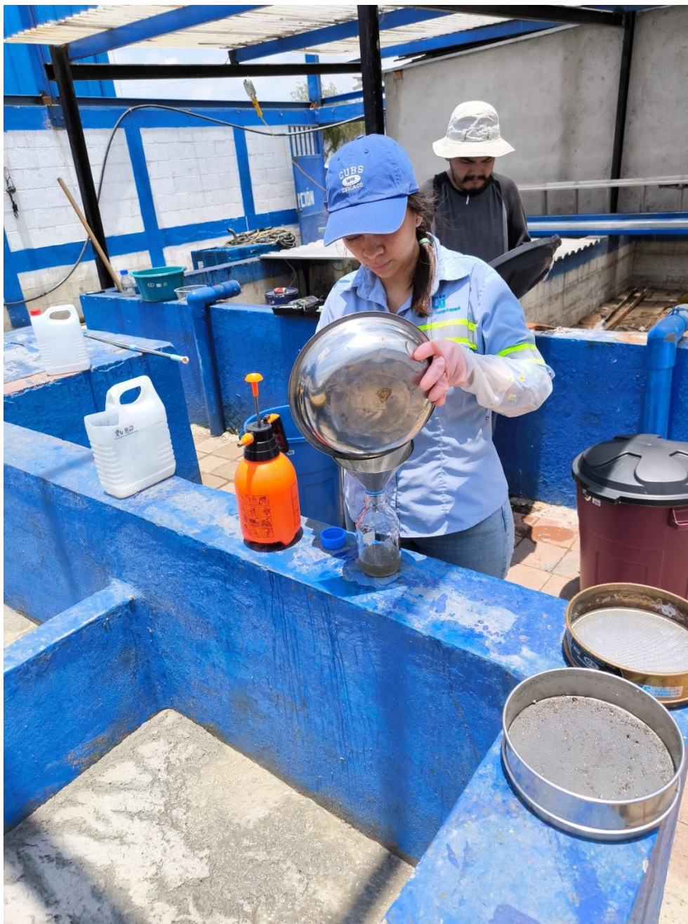
Ilustración II Filtración de MPS en uno de los 4 puntos de extracción, de una de las 4 plantas estudiadas.
