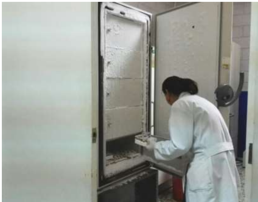
Fotografía 8: Almacenaje de las muestras que permanecerán congeladas a -80^{\circ}\text{C} para su conservación hasta el momento del procesamiento.
