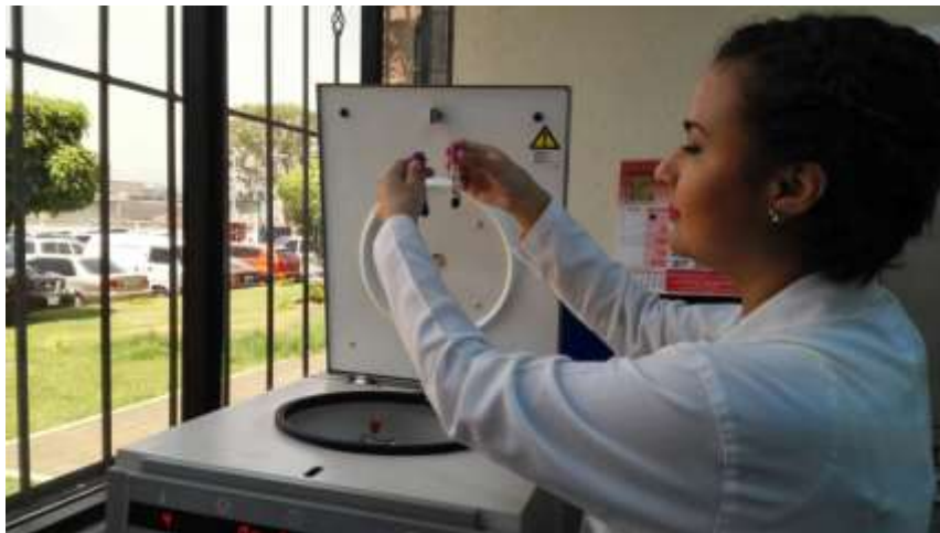
Fotografía 3: Balanceo de los tubos de ensayo previo a su centrifugación.
