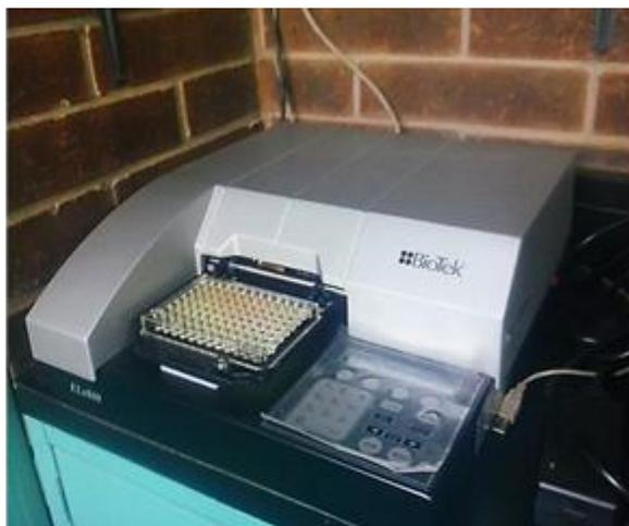
Ensayo de la actividad proteolítica del veneno de la serpiente *B. asper* y neutralización de la actividad por extractos estudiados. Medición de la degradación de azocaseína por espectrofotometría utilizando un lector de microplacas. Fotografías por: Nely Marroquín.
