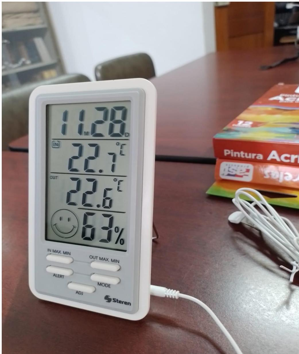
Termohigrómetro. Objeto que funciona con pilas AA, especial para medir la temperatura y humedad. Herramienta para coadyuvar a la preservación de los documentos
