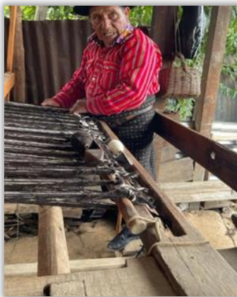
Figura 102 Telar de pie o de pedal
