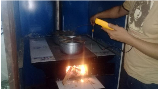
Termocupla para medición de temperatura de superficie.
