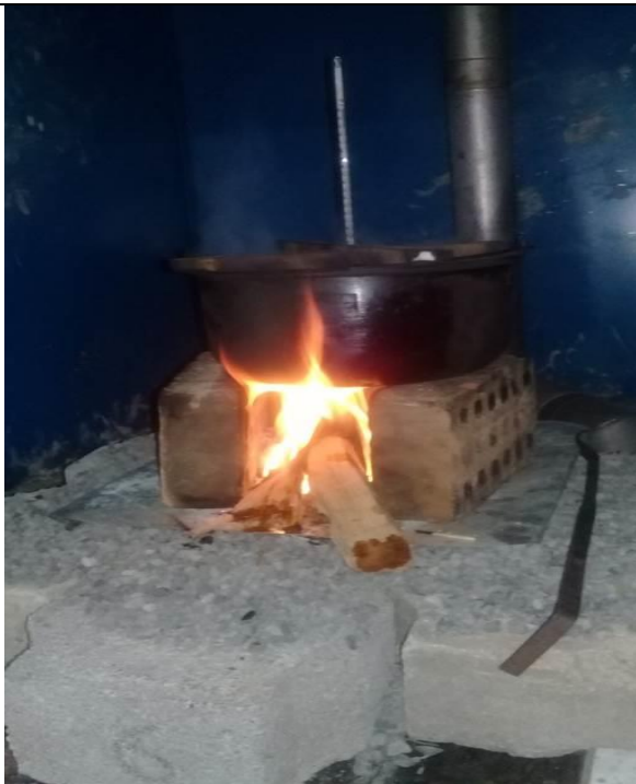
Prueba WBT en Fotón abierto
