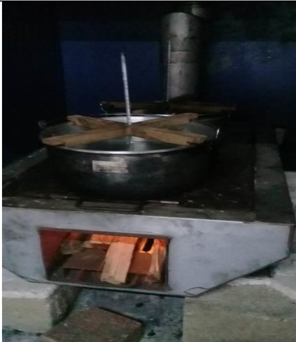
Control de temperatura en WBT
