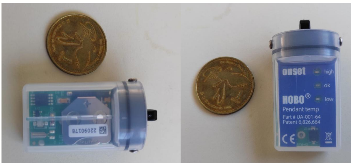
Fotografías 11 y 12. Nuevos sensores de temperatura de alta precisión para arena.
