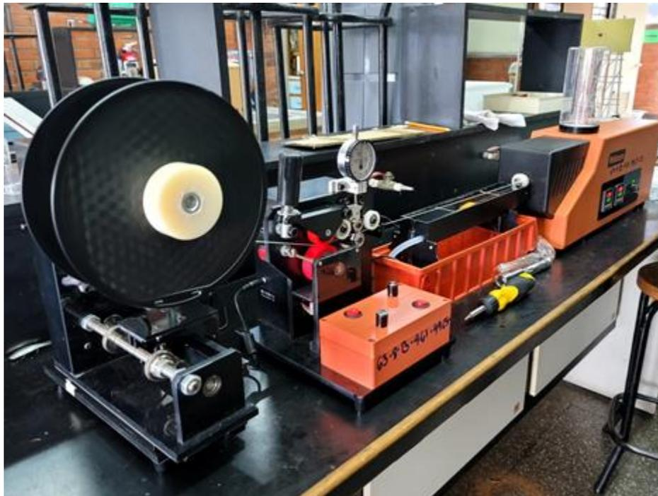
Equipo de extrusión de filamentos utilizado para la extrusión de ácido poliláctico
