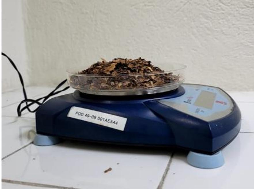
Pesando pulpa de café para la degradación básica
