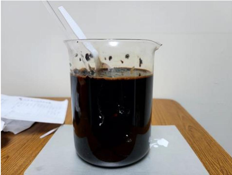
Muestra de pulpa de café después antes de ser lavada de la primera degradación
