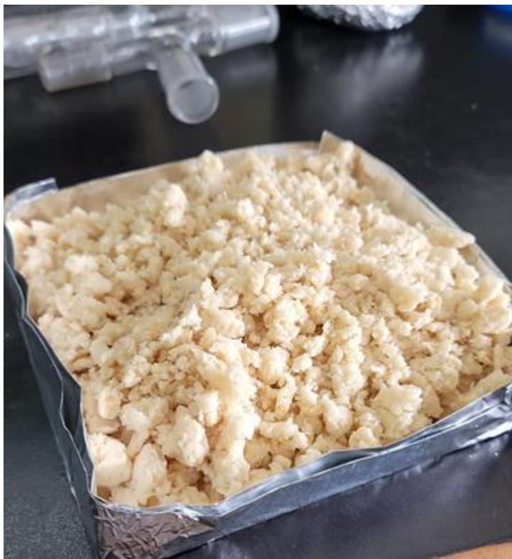
Secado de celulosa proveniente de laminado de bambú
