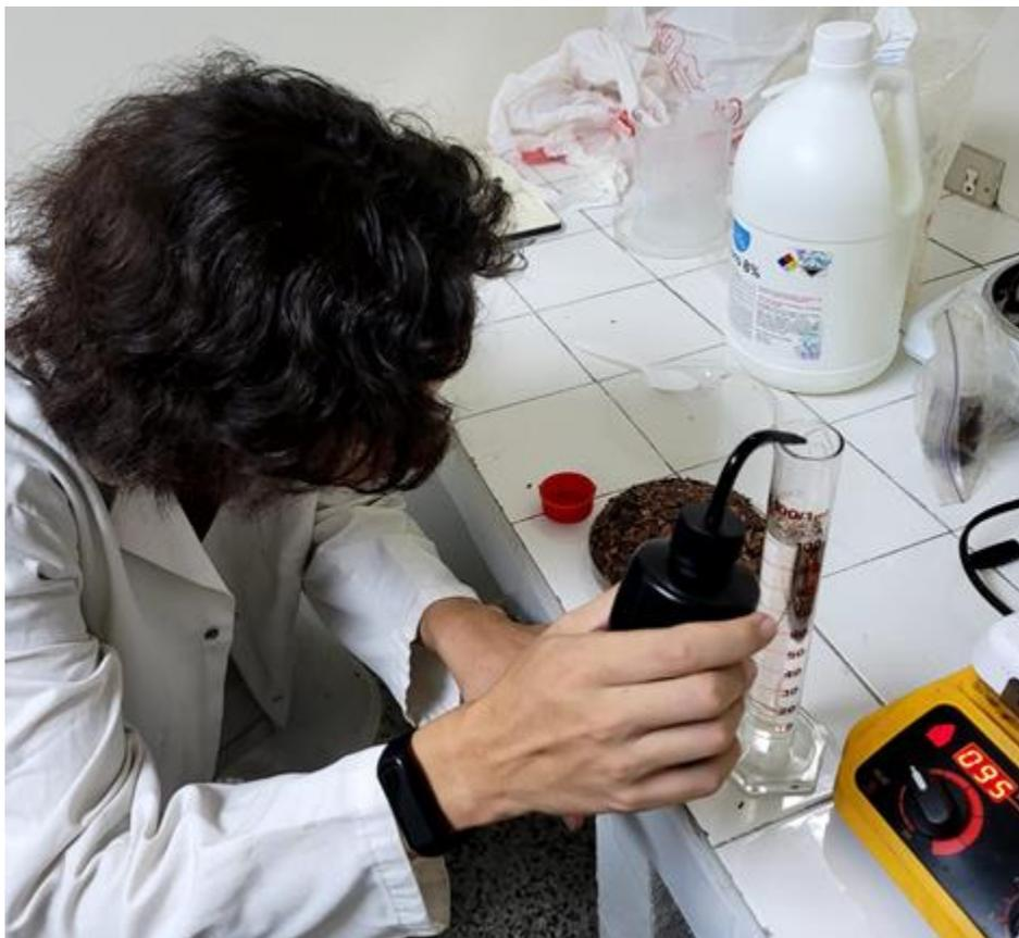
Aforando soluciones de hidróxido de sodio para las degradaciones
