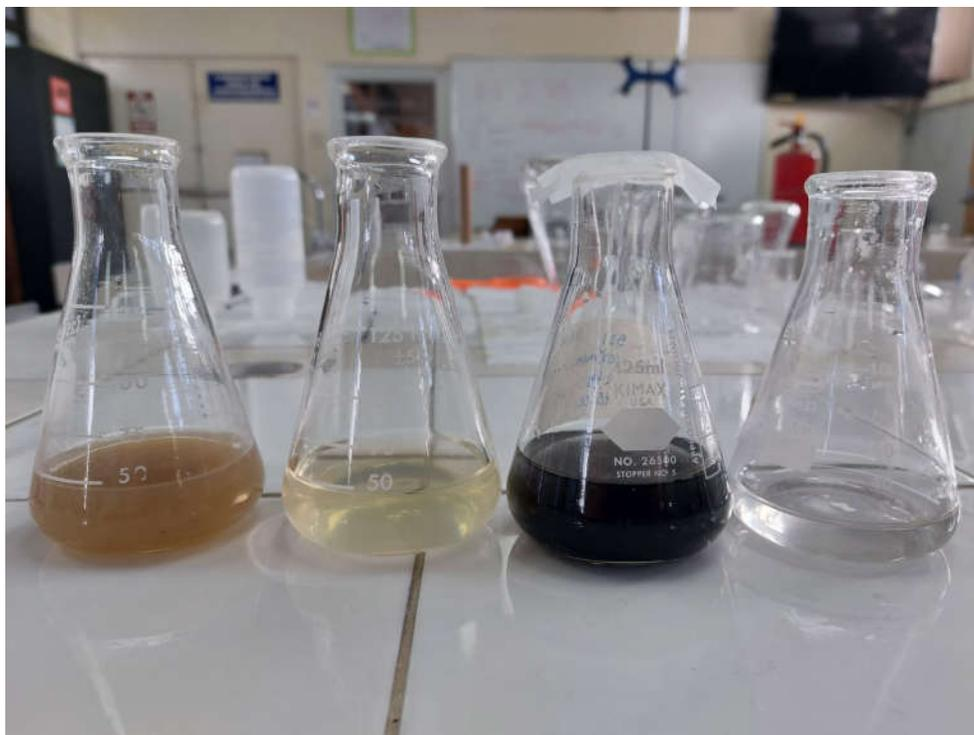
Nota: El primer recipiente del lado izquierdo contiene el agua residual sin ningún tratamiento, el segundo tratamiento contiene agua residual filtrada, el tercer recipiente contiene una muestra de agua miel mezclada con carbón activado comercial, el cuarto recipiente contiene una muestra de agua miel luego de pasar por el tratamiento con carbón activado comercial y ser filtrada para separarla del carbón activado.
