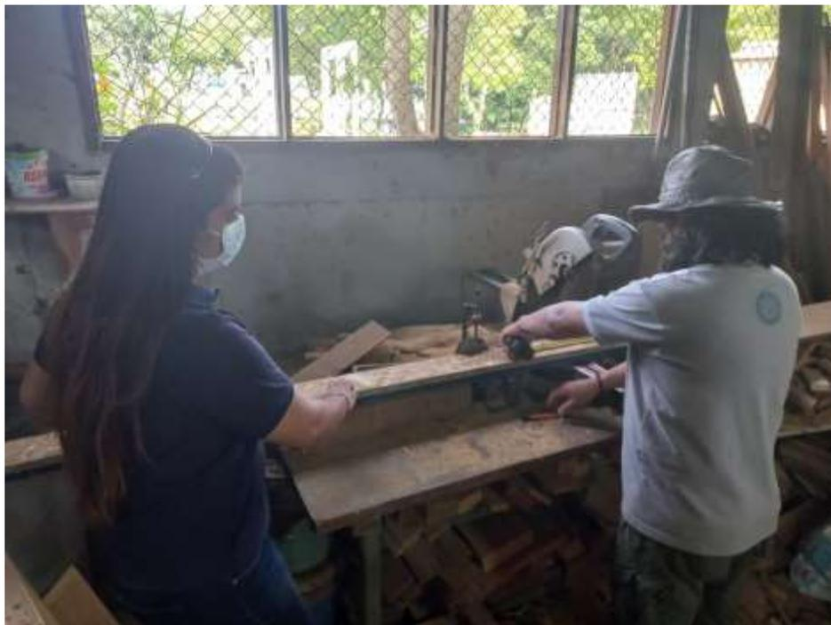
Corte de probetas para la determinación de dureza de los tableros OSB de  $\frac{3}{4}$  de pulgada de grosor.
