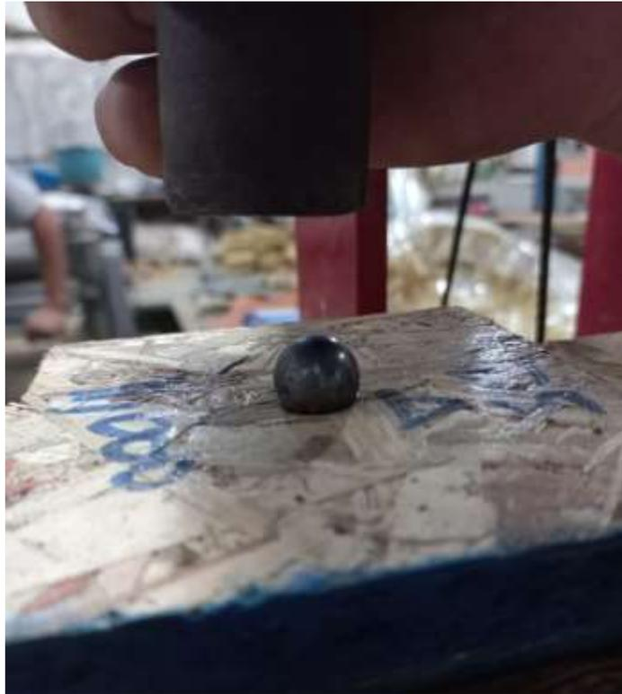
Ensayo de dureza Janka a tableros OSB de 3/4 de pulgada.
