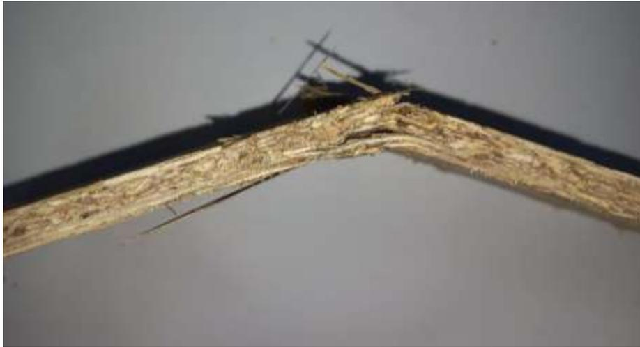
Ruptura de tableros OSB ensayados .
