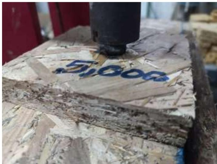
Ensayo de dureza Janka a tableros OSB de 3/8 de pulgada.
