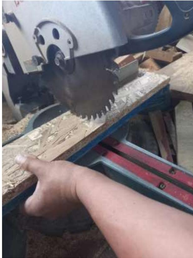
Corte de probetas de un pie de largo y 4 pie de grosor para las pruebas de flexión.
