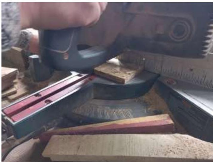
Corte de probetas para la determinación del ensayo de absorción y dureza de los tableros OSB.
