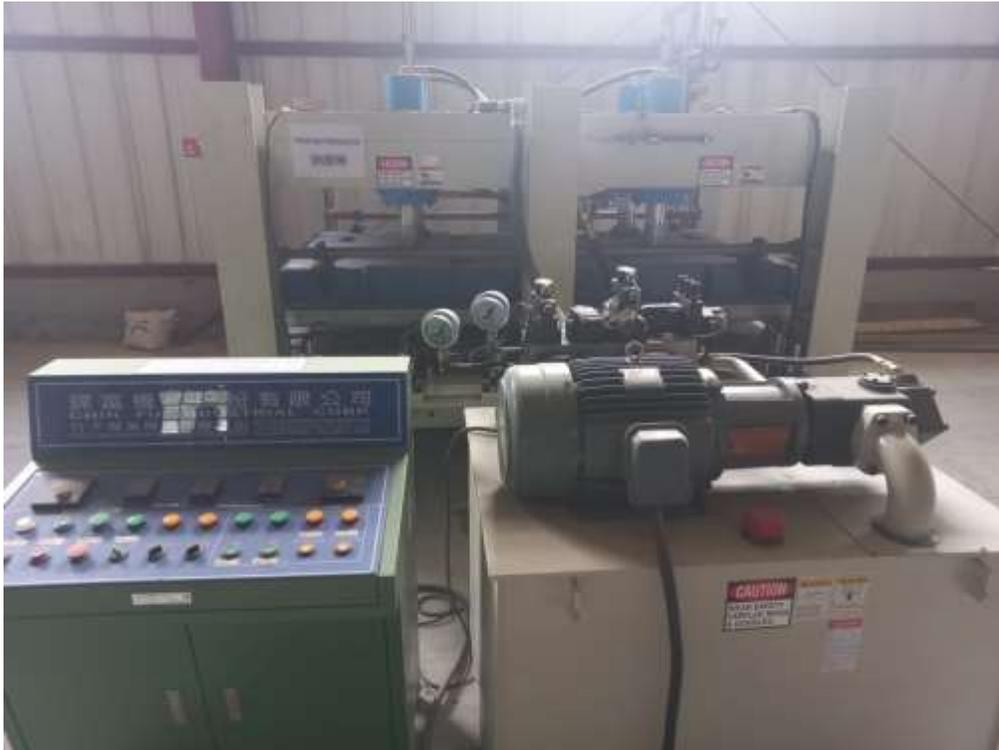
Utilización de prensa trial Axial para la fabricación de tableros OSB en el Centro de Trasmformacion e Investigacion del Bambu.
