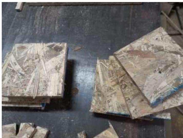
Probetas utilizadas para la determinación de la dureza Janka de tableros OSB 3/8 y 1/2 de pulgada.
