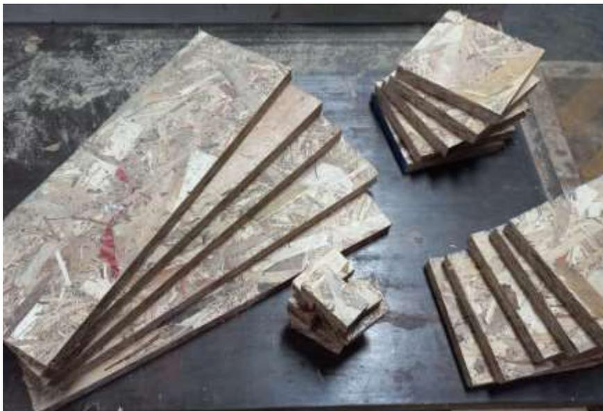
Juego de probetas para la determinación del ensayo de flexión, adsorción, dureza y densidad de tableros OSB de ½ pulgada.
