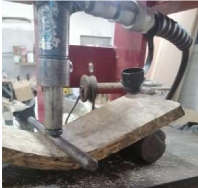
Ensayo de flexión a tableros OSB con 10 % de finos.
