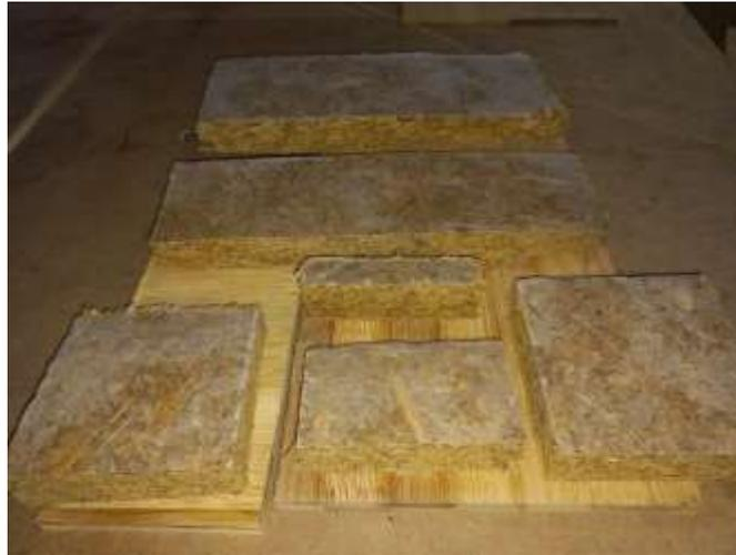
Juego de probetas de tablero de virutas orientadas de bambù.
