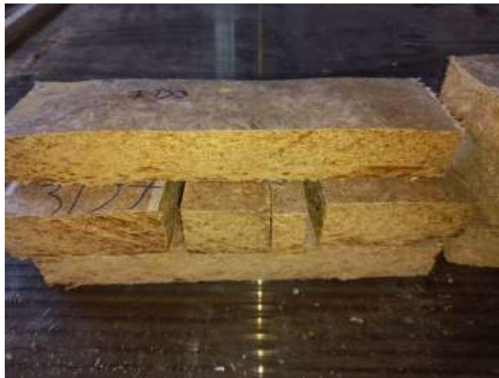
Perfil de corte de tablero de virutas orientadas de bambù .
