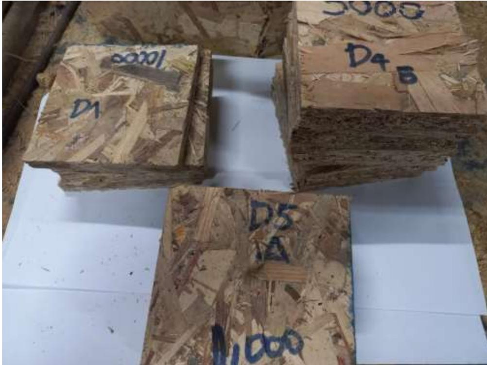
Juego de probetas de tableros OSB para la prueba de dureza Janka.
