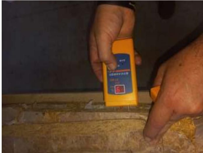
Midición de humedad de los tableros de virutas orientadas de bambù.
