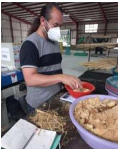
Pesado del aserrín de bambu para la realización de las mezclas.
