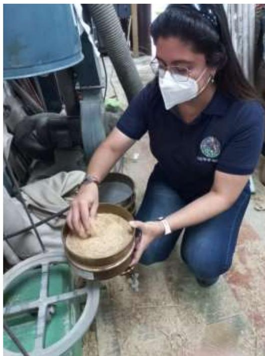
Tamizado de los subproductos provenientes del proceso de laminado de bambú.
