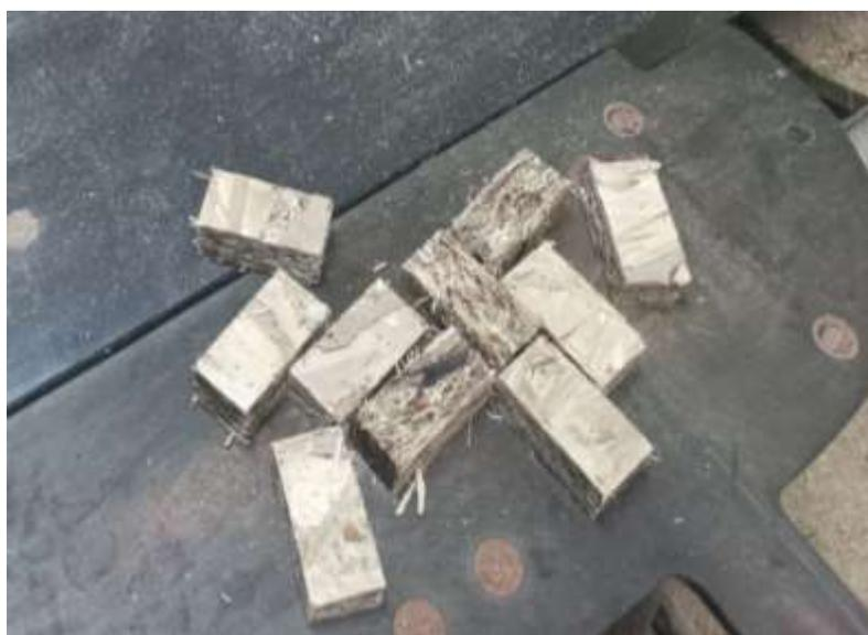
Juego de probetas utilizadas en el ensayo de densidad de tableros OSB de  $\frac{3}{4}$  de pulgada de grosor.
