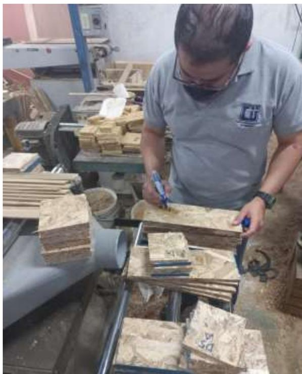
Corte de probetas para la determinación del porcentaje de humedad de tableros OSB de 3/8 de pulgada .
