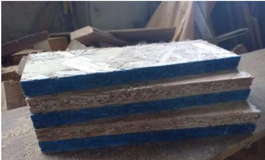
Juego de probetas para el ensayo de flexión del tablero comercial de  $\frac{3}{4}$  de pulgada.
