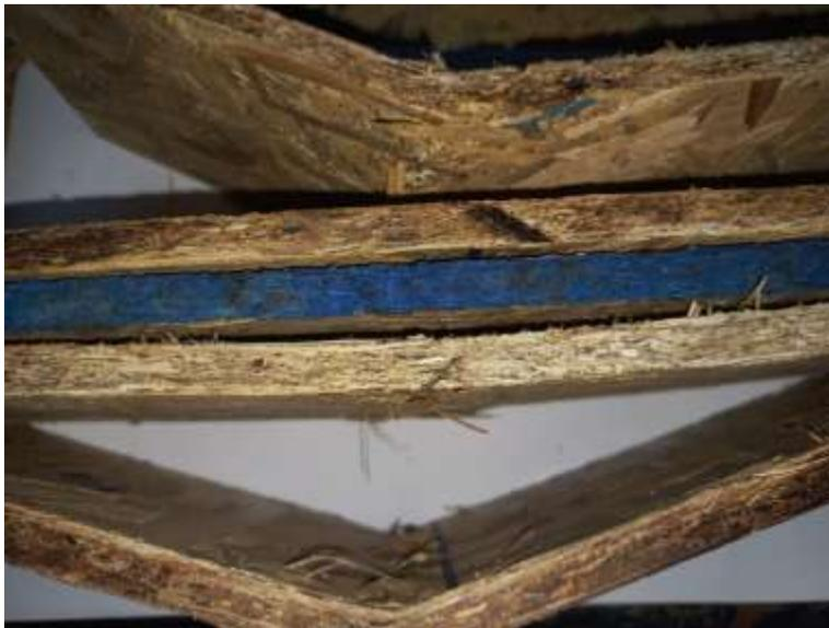
Juego de probetas utilizadas en el ensayo de flexión llevadas a la ruptura .
