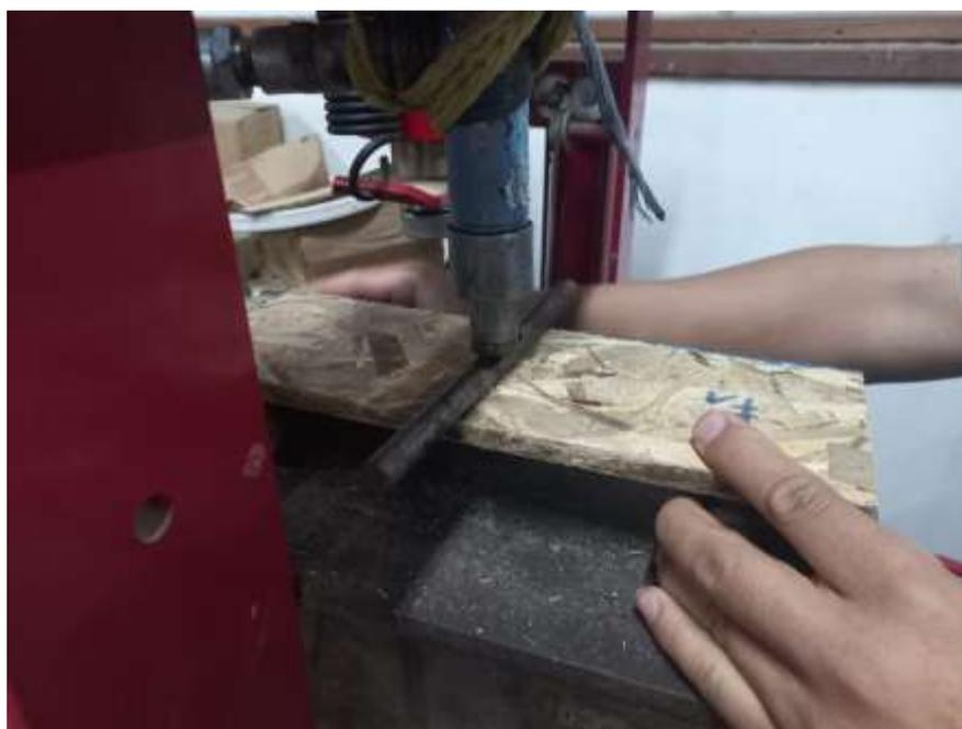
Ensayo de flexión a tablero OSB de 3/4 ,1/2 y 3/8 de pulgada.
