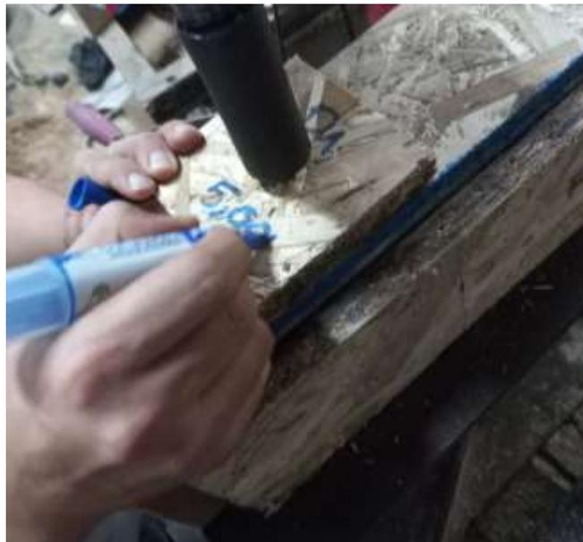
Identificación de las probetas para los respectivos ensayos.
