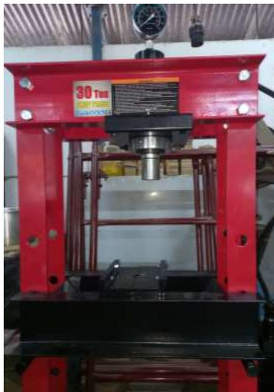
Prensa Hidraulica utilizada para la fabricacion preliminar de los tableros OSB.
