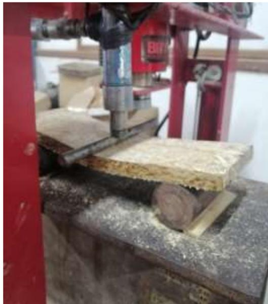
Ensayo de flexión a tableros OSB con 20 % de finos.
