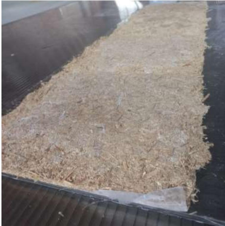
Tablero de virutas orientadas fabricado en el Centro de Transformación e Investigación de Bambú, de dimensiones 4x1 pie.
