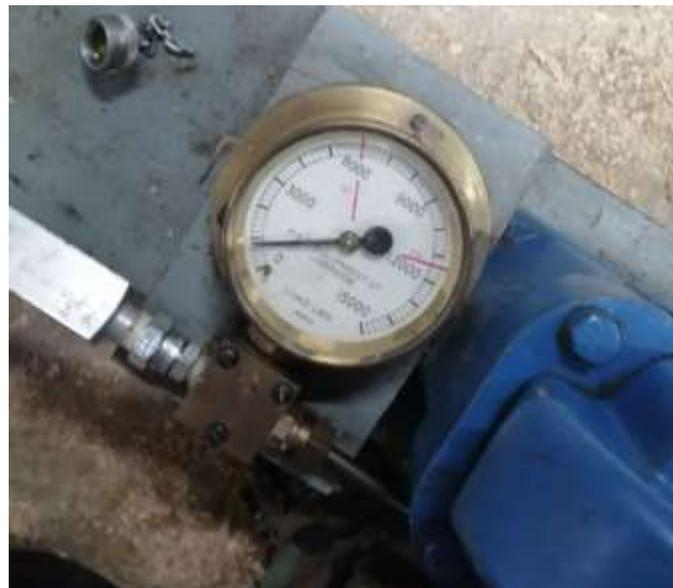
Lectura en el manómetro de la presión ejercida sobre las probetas ensayadas.
