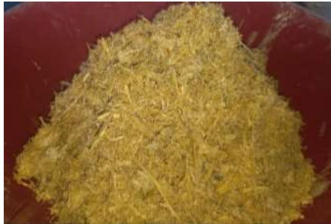
Mezcla de virutas de bambù y pegamento para introducirla en el molde para el prensado en caliente.
