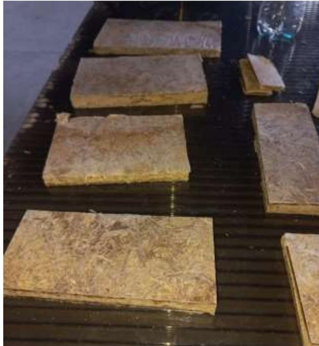
Probetas cortadas de los tableros de virutas orientadas de bambú con grosores de  $\frac{1}{2}$  pulgada de grosor.
