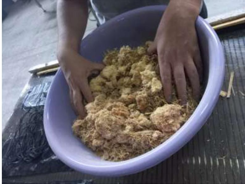
Realización de las mezclas de pegamento con virutas de aserrín de bambù.
