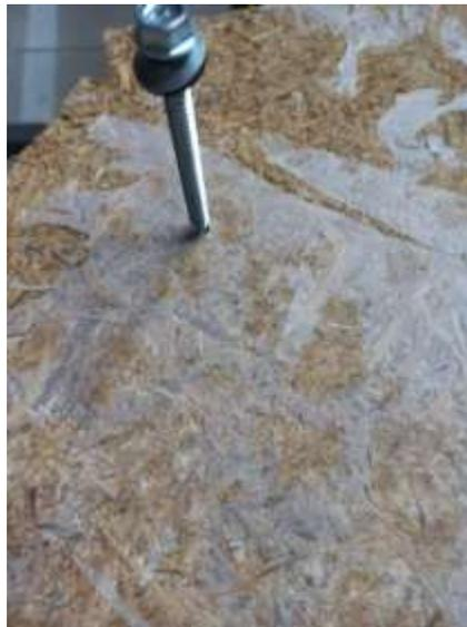
Perforacion con tornillos punta de broca en tableros de virutas orientadas de bambù.
