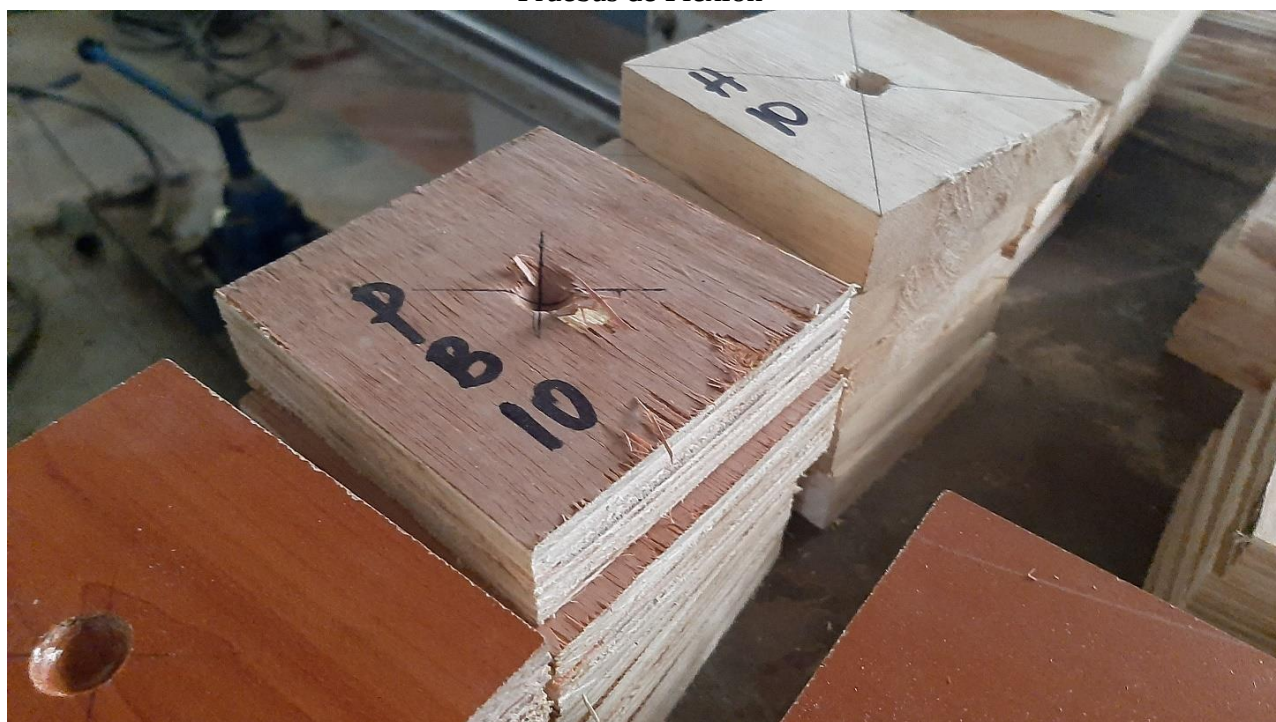
Probetas ensayadas dureza ya ensayadas
