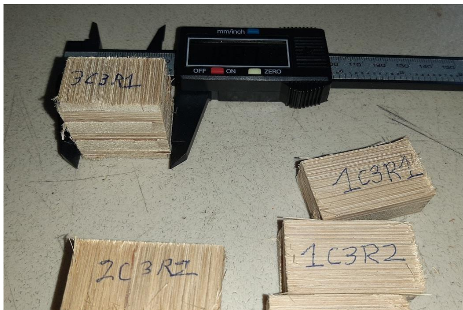
Determinación de las dimensiones de probetas para determinar sus volúmenes
