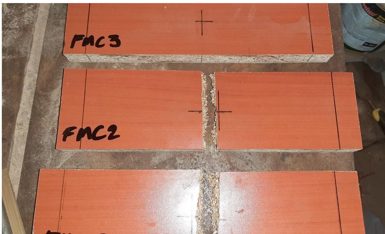
Probetas ensayadas en flexión de melanina
