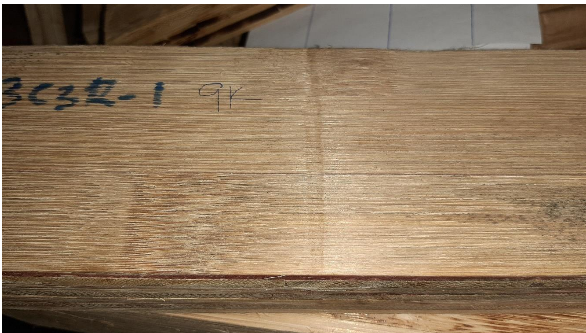
Probeta de tablero laminado fallado a flexión
