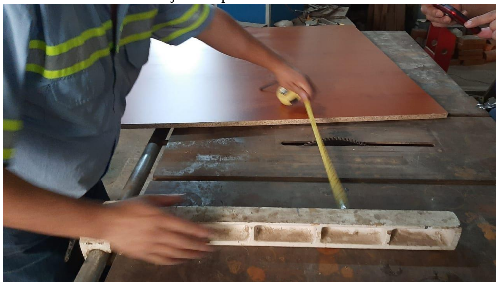
Reducción de los tableros de 6X8 y 4X8 pies a tamaños manejables para cortes de probetas de ensayos
