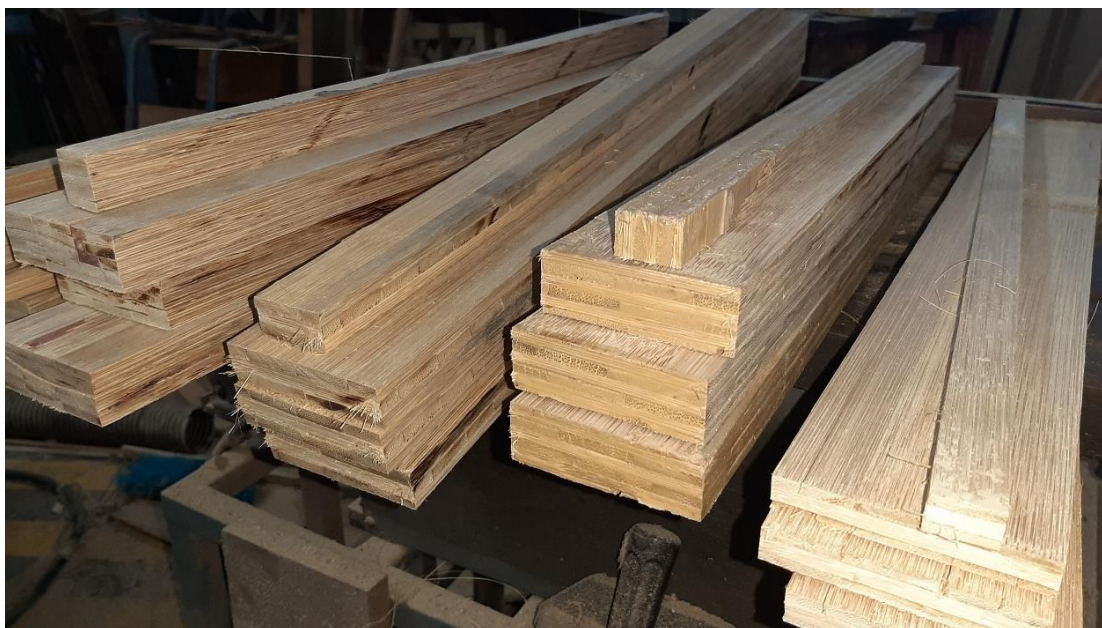
Probetas para el ensayo de flexión de los tableros laminados
