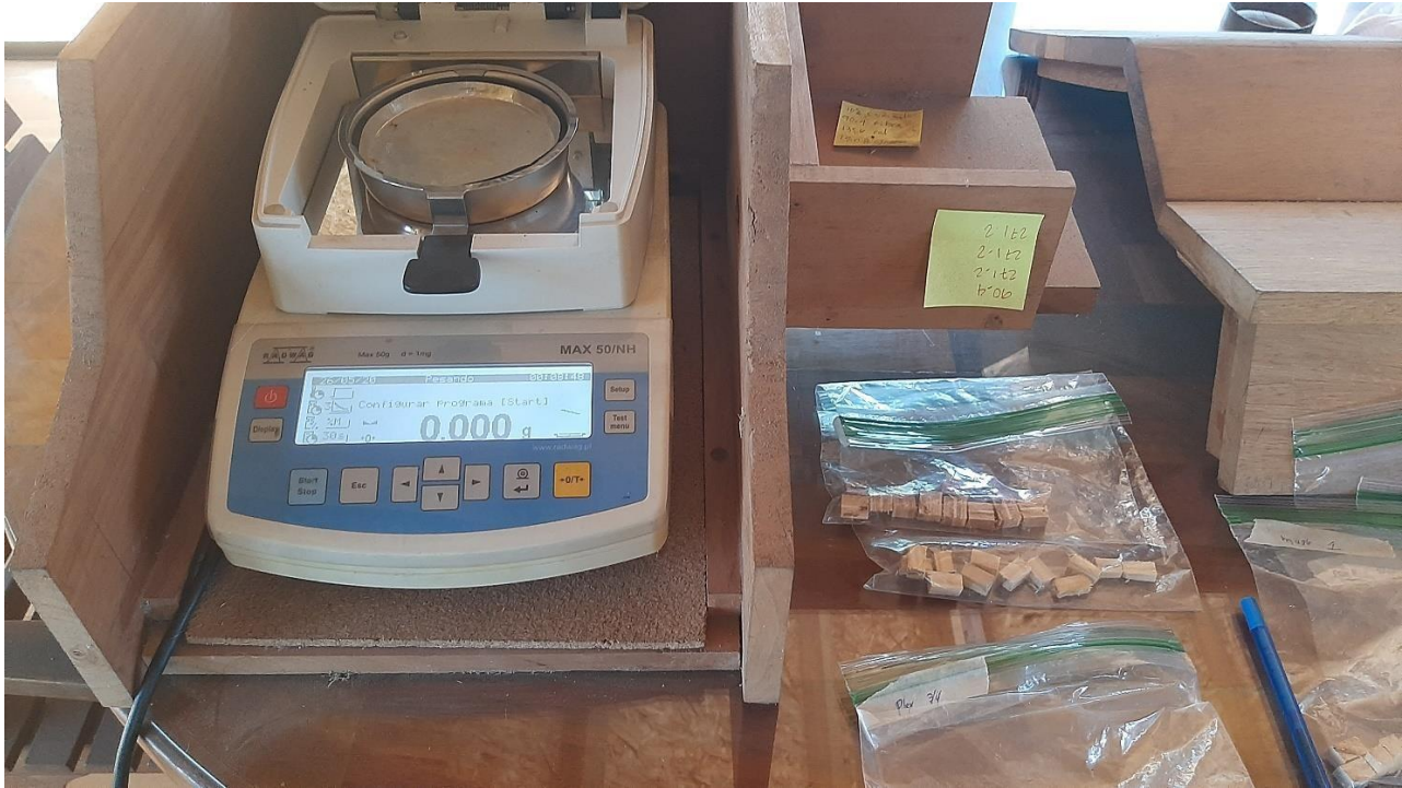
Ensayo de Humedad
