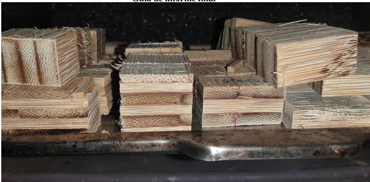
Secado de probetas de tableros laminados de bambú
