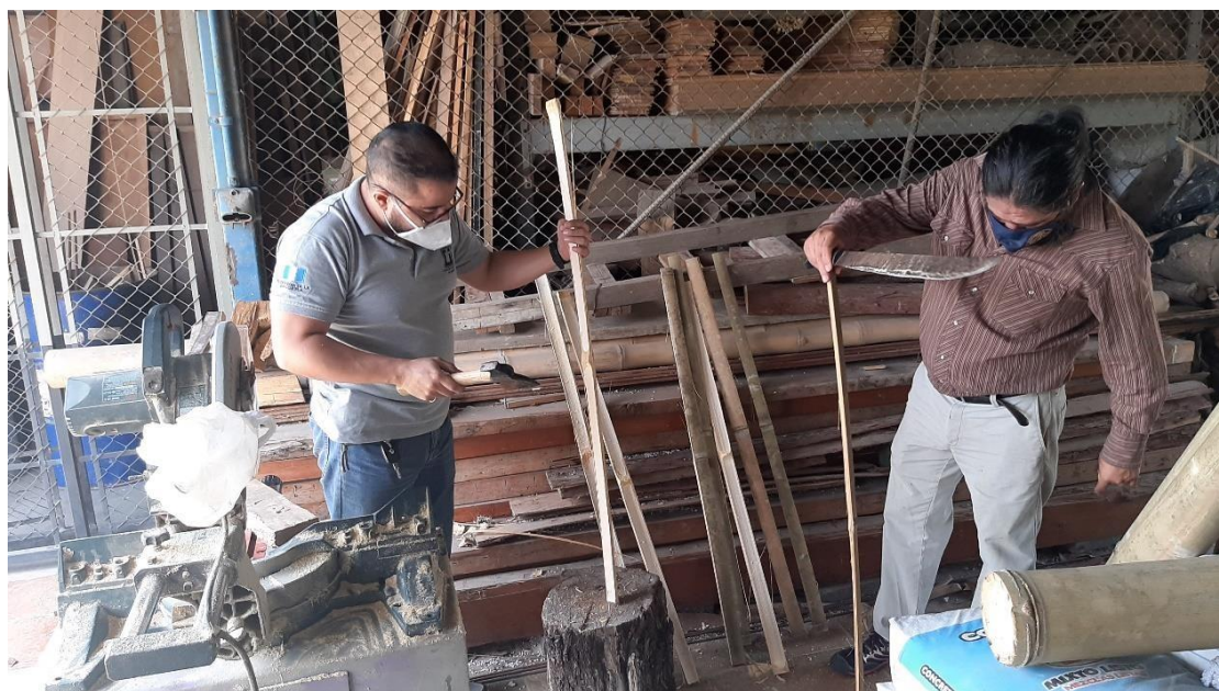
Corte de latillas manual de bambú para empezar a laminar
