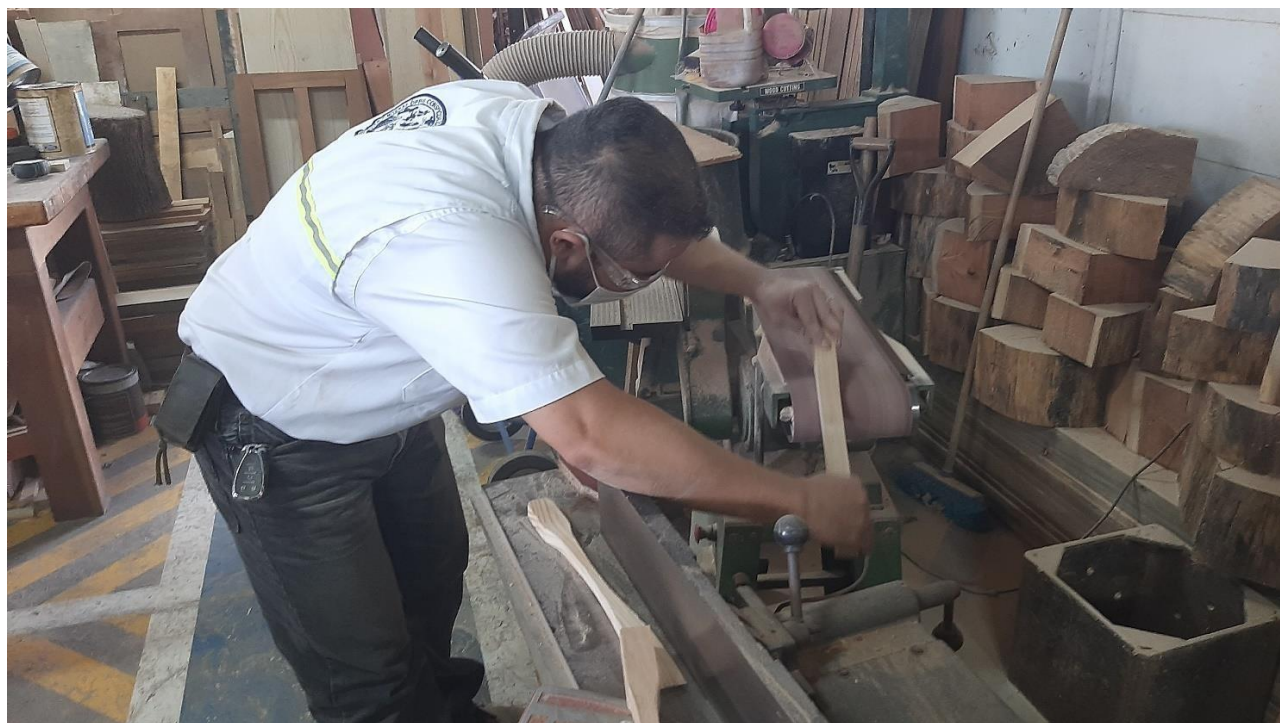
Corte de probetas de dureza
