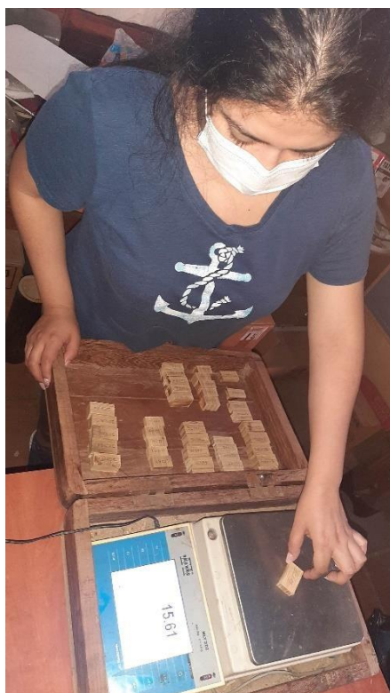
Pesado de probetas de los tableros laminados
