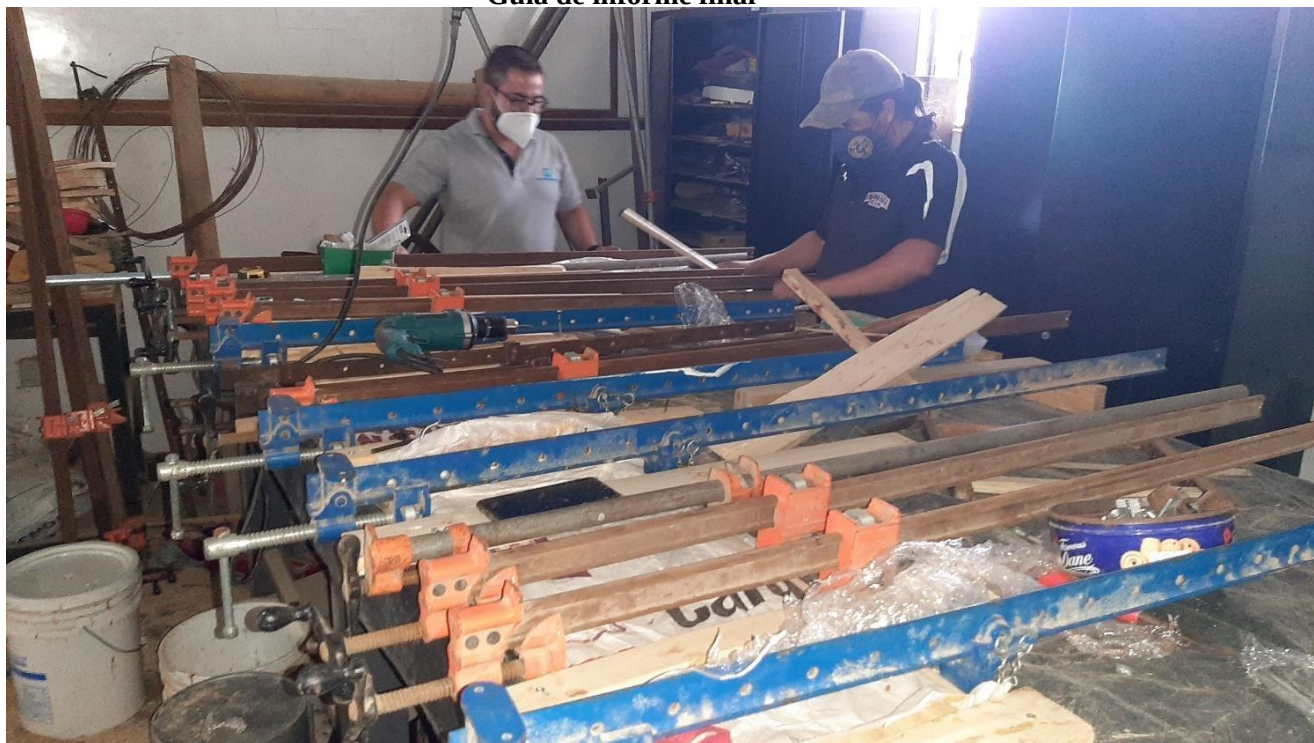
Utilizando diferentes sargentos para mantener las latillas juntas y a escuadra para conformar tableros
