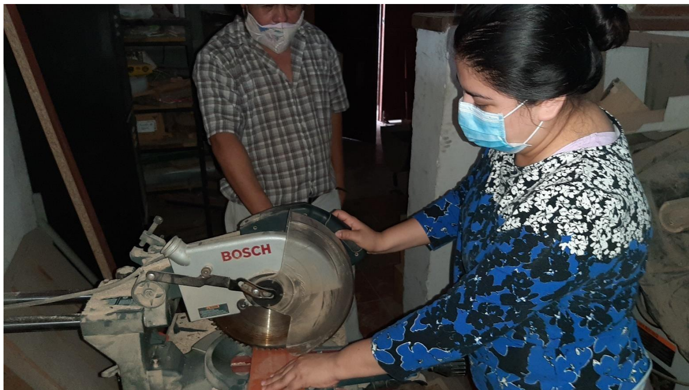
Corte de probetas de dureza
