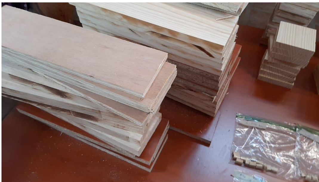
Probetas cortadas de ensayo de flexión, humedad y dureza
