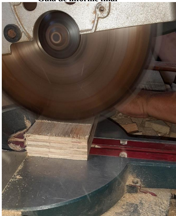
Corte de probetas para medir la densidad
