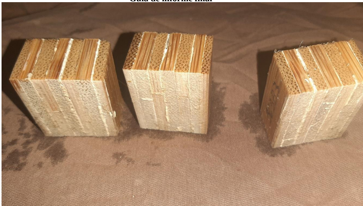
Probetas sumergidas 24 horas en agua
