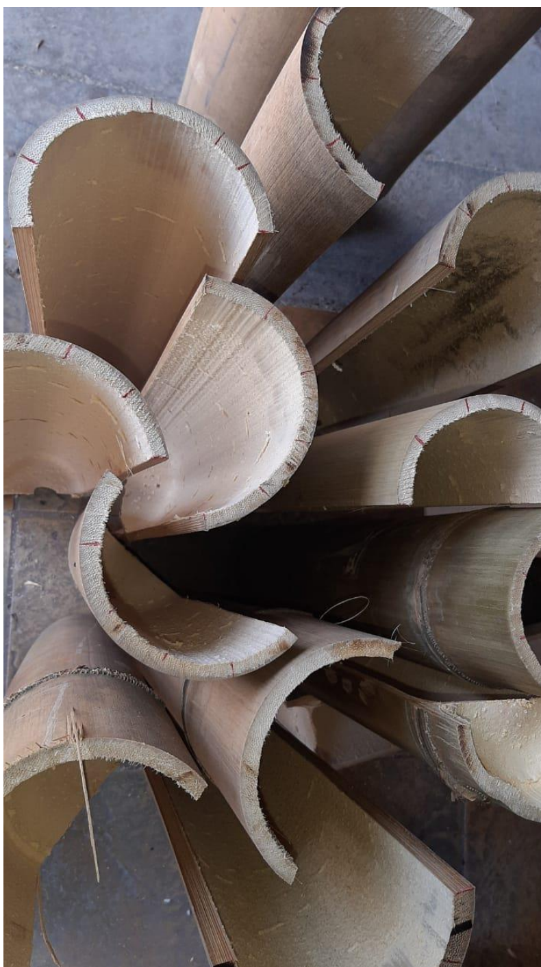
Bambú cortado a la mitad y marcado para cortar las latillas
