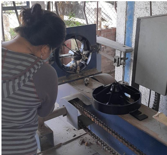
Colocación de las cuchillas para latillar
