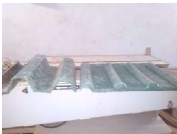
Comparación de las tejas misma formulación distinta morfología
