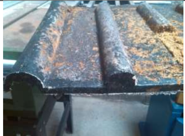
Teja fabricada con polipropileno al 75 % de polímero
