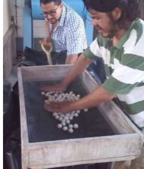
Separación del polímero en el molino de bolas
