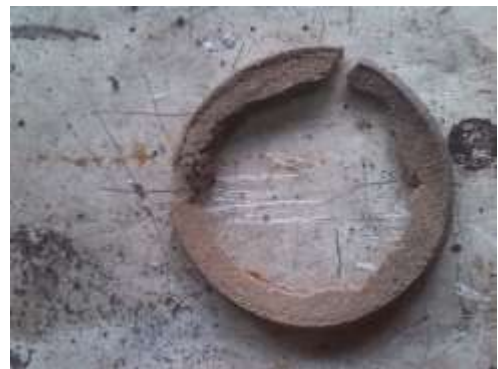
Membrana colapsada por el caudal
