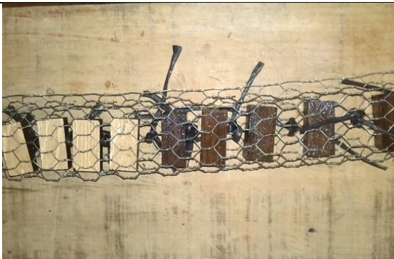
Corte de las probetas de tensión de los pisos fabricados
