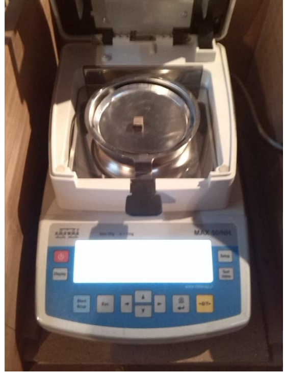
Determinación de la humedad con la balanza de humedad
