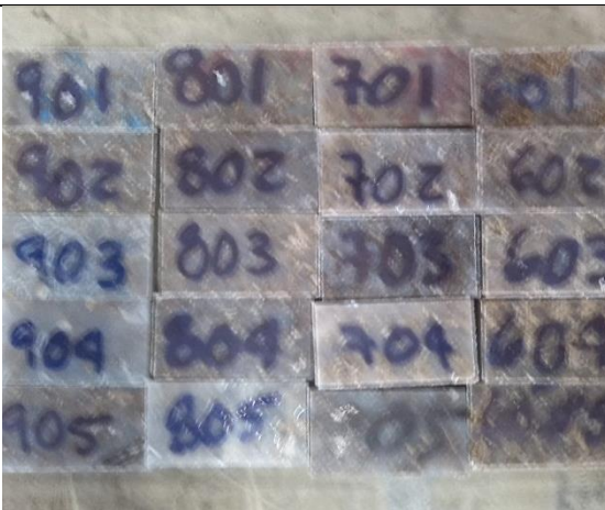
Probetas de madera plástica de bambú para la prueba de densidad
