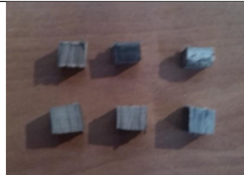
Probetas para determinar la humedad en pisos de madera solida
