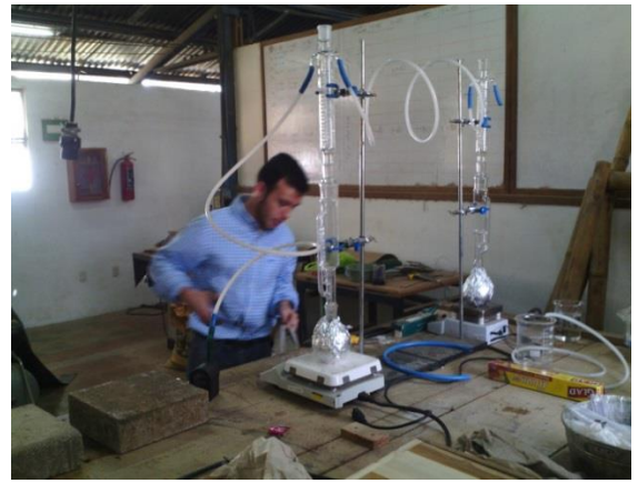
Armado del equipo de extracción para determinar la cantidad de extraíbles
