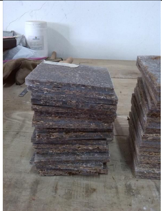
Probetas de pisos de madera plástica de madera para la prueba de absorción
