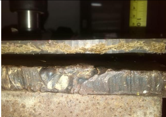
Probetas para la prueba de contracción volumétrica de los pisos comerciales
