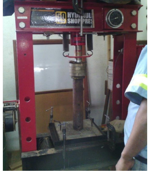
Determinación de la presión adecuada para la fabricación de los pisos
