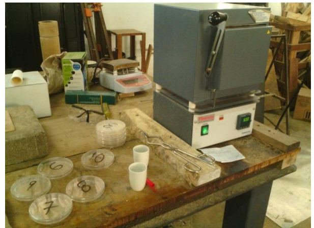
Equipo utilizado para determinar el contenido de cenizas
