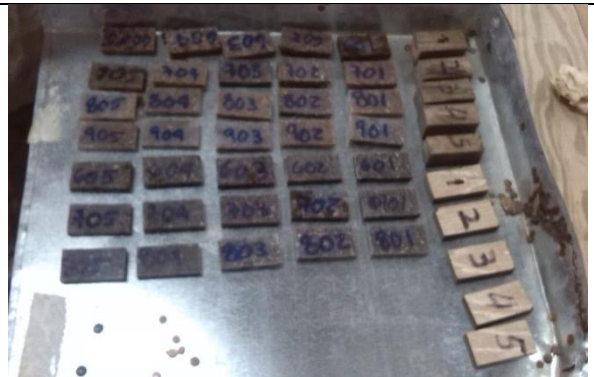
Corte de las probetas de tensión de los pisos comerciales
