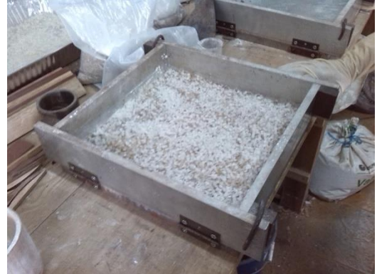
Plástico con aserrín en los moldes
