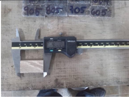
Determinación del largo de las probetas para el ensayo de densidad
