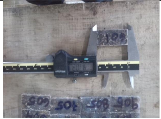
Determinación del largo de las probetas de madera plástica
