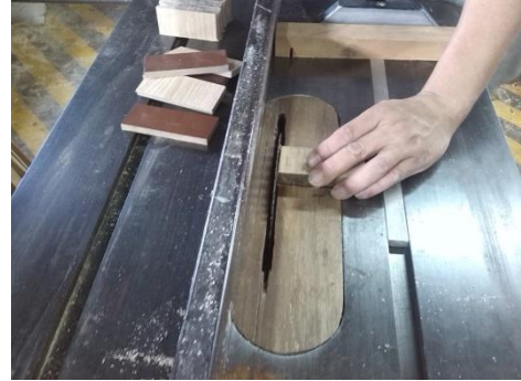
Corte de los pisos de madera plástica de bambú para la prueba de contracción volumétrica
