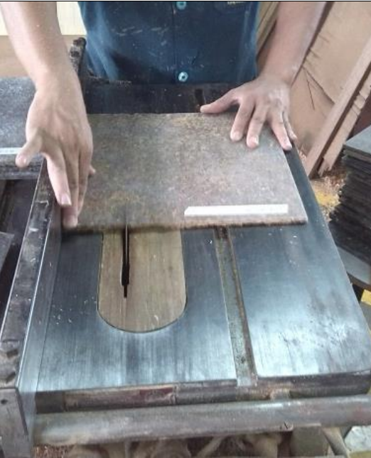
Corte de los pisos de madera plástica de madera para la prueba de contracción volumétrica
