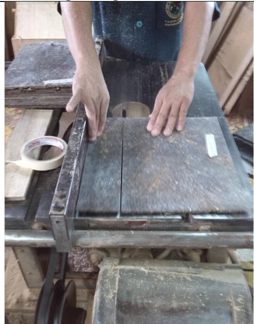
Probetas de pisos de madera plástica de madera para la prueba de absorción
