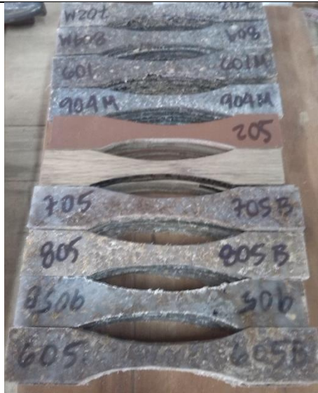
Probetas de los pisos fabricados para realización de la prueba de tensión
