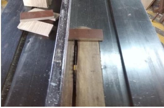
Corte de los pisos de madera plástica de madera para la prueba de contracción volumétrica
