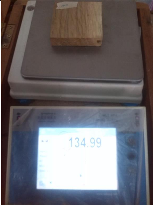
Pesado de las probetas para la prueba de absorción de los pisos laminados
