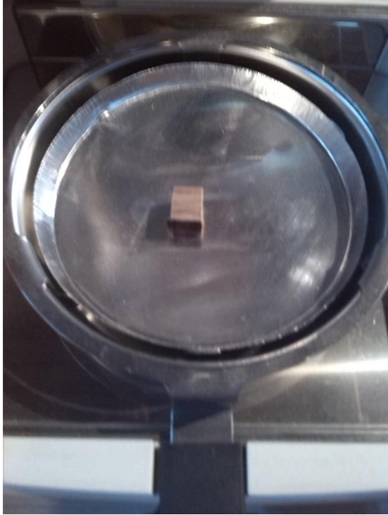
Determinación de la humedad con la balanza de humedad
