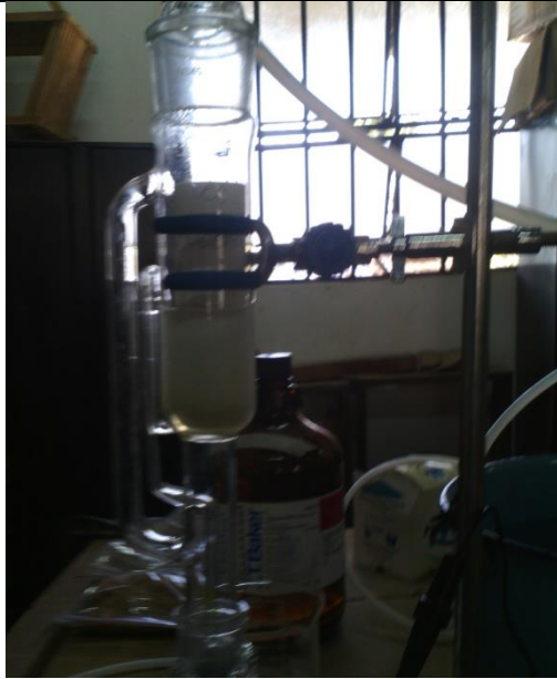
Dedal de celulosa colocado en el equipo de extracción
