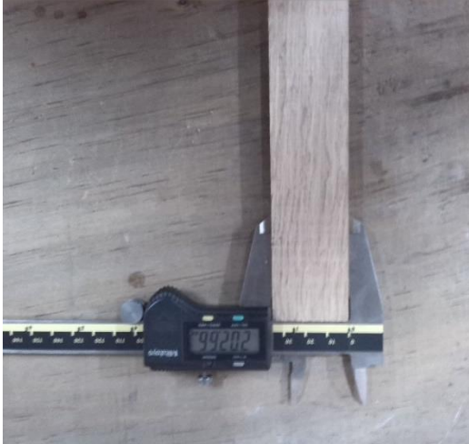
Medición del ancho de las probetas de los pisos laminados
