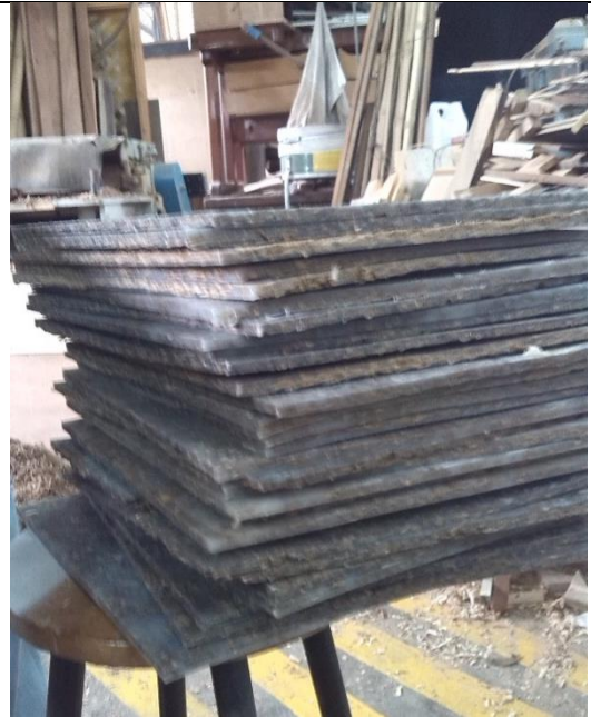
Corte de los pisos de madera plástica de bambú para la prueba de contracción volumétrica
