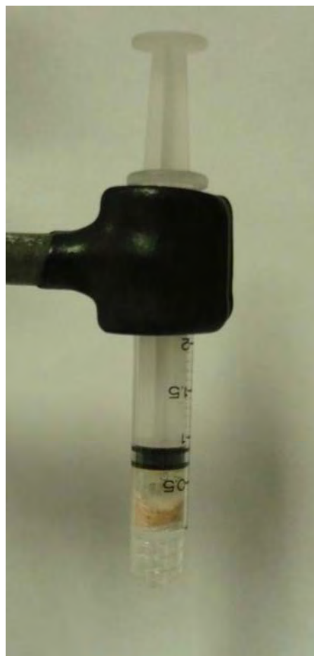
Fotografía 9.4. Montaje de una columna empacada para extracción metálica.
