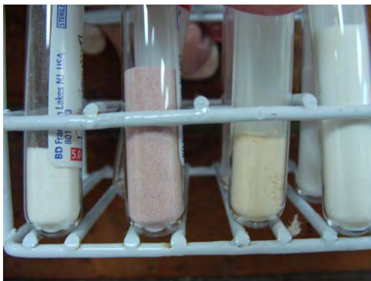
Fotografía 9.1. Muestras de material polimérico sintetizados en el laboratorio. De izquierda a derecha: a) 3-cloropropiltrimetoxisilano+ dimetilgloxima (medio NaOH), b) Tetrametoxisilano + 1,5-difenilcarbazida (medio KOH) c) Viniltrimetoxisilano + 1,5-difenilcarbazida (medio NaOH) d) 3-cloropropiltrimetoxisilano+ dimetilgloxima (medio KOH)
