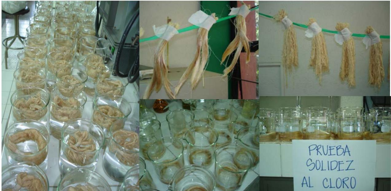
La prueba de solidez al cloro es la propiedad de resistencia del colorante sobre la fibra sobre la acción del cloro, utilizando una solución de hipoclorito de sodio conteniendo 20 mg/L de cloro activo, durante 4 horas a temperatura ambiente. Se observó que las fibras no sufrieron decoloración, por lo que se le asigna un valor de solidez de 5 (excelente resistencia del colorante sobre la fibra a la acción del cloro), para ambos colorantes y ambas fibras.
