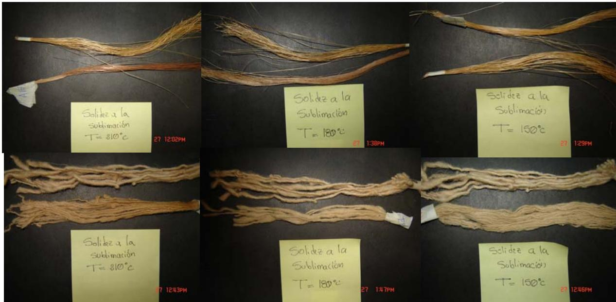
La prueba de solidez a la sublimación se refiere a la resistencia de la fibra teñida a la acción del calor, durante 30 segundos, a 3 diferentes temperaturas. Las fibras calentadas con planchas por ambos lados, a la misma temperatura utilizando la misma presión.
