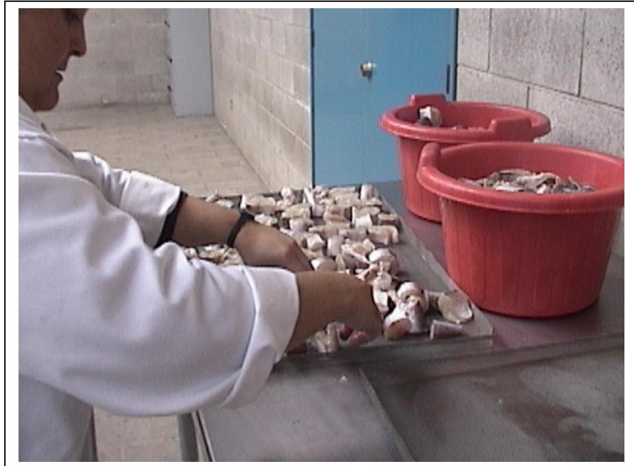
Colocación de las rodajas de pescado en bandejas previo al proceso de ahumado
