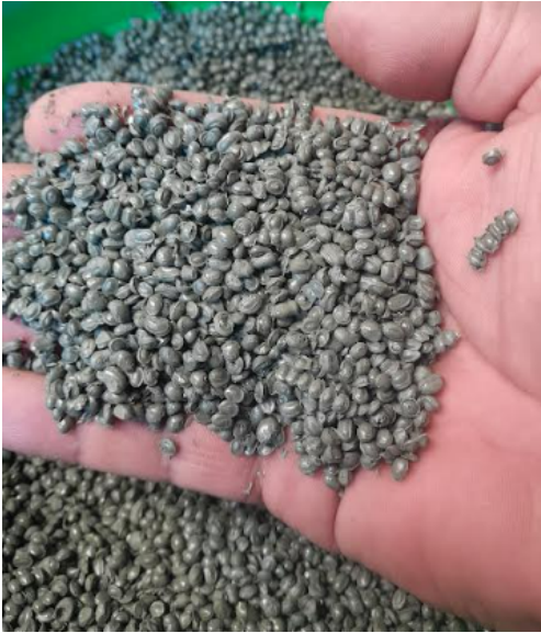
Pélets de PVC reciclado de 3.0 a 5.0 mm
