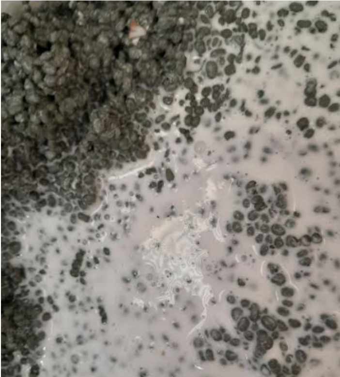
Resina de urea formaldehído antes de ser mezclada con pélets de PVC reciclado
