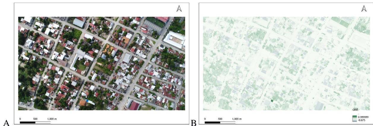
**Figura 4.** Comparación de imágenes tomadas por dron Phantom 4 (A), con imágenes al calcular el índice de vegetación verde-rojo (B).
