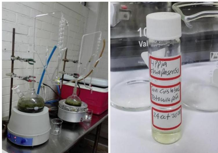
**Fotografía 4.** a) Extracción simultánea de aceite esencial de hojas de *L. chiapasensis* en aparatos Clevenger. b) Aceite esencial obtenido de hojas de *L. chiapasensis* pesado y etiquetado. Fotografías por Max Mérida.
