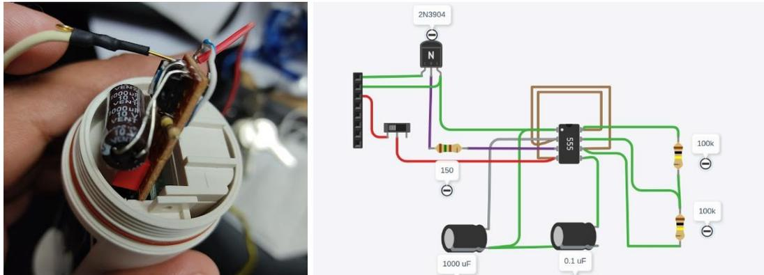
Nota: A la izquierda tarjeta física insertada en el instrumento, a la derecha, diagrama de conexión y descripción de componentes discretos. Elaboración propia.
