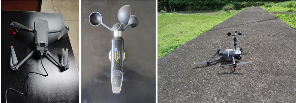
Nota: a la izquierda, dron DJI Mavic 3, al centro, anemómetro PCE ADL 11, a la derecha, sistema ensamblado para monitoreo. Elaboración propia.
