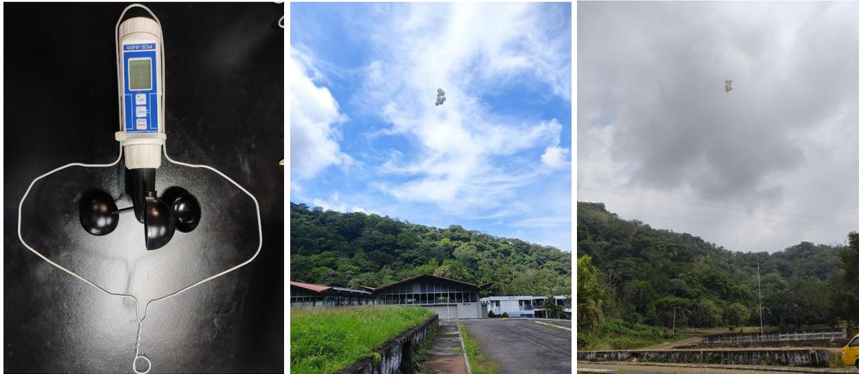
Nota: a la izquierda, anemómetro PCE A420 con armazón de acero galvanizado, al centro y derecha pruebas de monitoreo con el empleo de globos inflados con helio. Elaboración propia.
