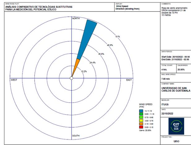
Rosas de viento producto de los datos obtenidos con el anemómetro instalado en el mástil (izquierda) y el anemómetro elevado con el uso del dron (derecha); fecha y hora, 21 de octubre de 2022 a las 15:00 hrs, se considera la misma dirección del viento dada la cercanía entre los dos instrumentos durante la medición, imágenes obtenidas con el empleo de WRPLOT VIEW 8.0.2. La magnitud de los datos obtenidos con el anemómetro del dron es diferente en comparación con los obtenidos en el mástil.
