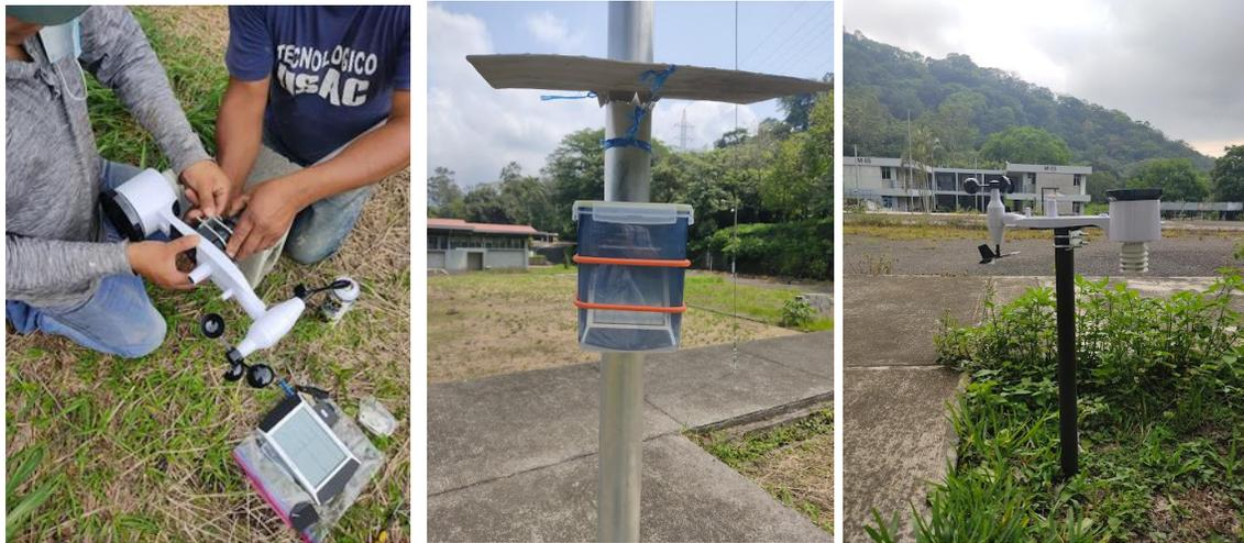
Nota: a la izquierda, instalación de equipo FWS 20N en extremo del mástil y pantalla *data logger*, al centro, resguardo del *data logger* en el mástil con recipiente hermético, a la derecha muestra cercana del instrumento FWS 20N con anemómetro de cazoletas, veleta, higrómetro y termómetro. Elaboración propia.
