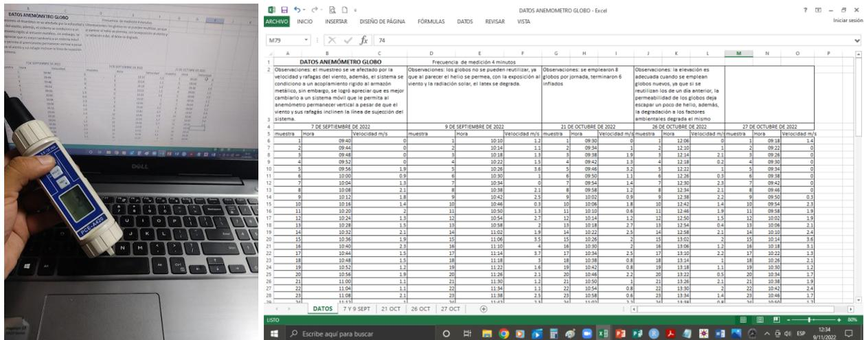
Nota: para la obtención de los datos el anemómetro A420 posee tres botones que sirven para desplazarse a través de la memoria interna y en una pantalla LCD, leer directamente los datos capturados, estos se trasladan a una hoja electrónica en formato MS Excel para su procesamiento e interpretación. Elaboración propia.
