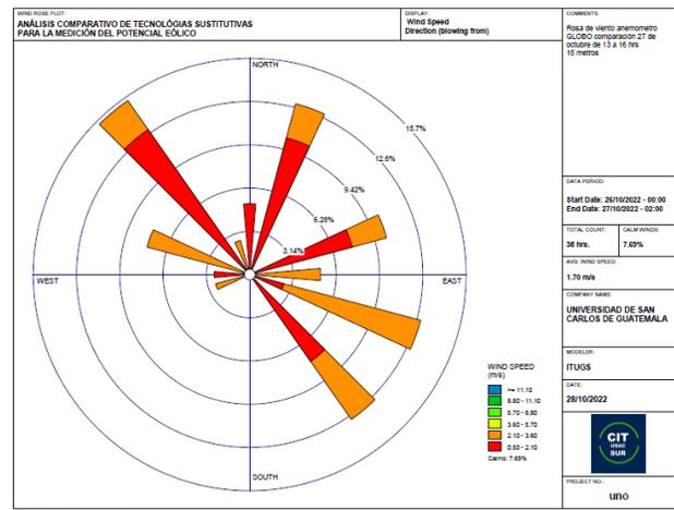
Rosas de viento producto de los datos obtenidos con el anemómetro instalado en el mástil (izquierda) y el anemómetro elevado con el uso de globos inflados con helio (derecha); fecha y hora, 27 de octubre de 2022 de 13 a 16 hrs, se considera la misma dirección del viento dada la cercanía entre los dos instrumentos durante la medición, imágenes obtenidas con el empleo de WRPLOT VIEW 8.0.2. Los datos son muy similares.
