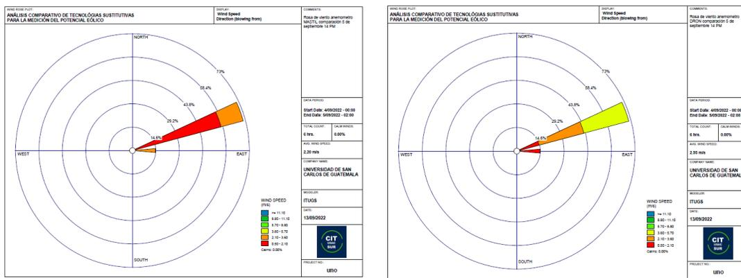
Rosas de viento producto de los datos obtenidos con el anemómetro instalado en el mástil (izquierda) y el anemómetro elevado con el uso del dron (derecha); fecha y hora, 5 de septiembre de 2022 a las 14:00 hrs, se considera la misma dirección del viento dada la cercanía entre los dos instrumentos durante la medición, imágenes obtenidas con el empleo de WRPLOT VIEW 8.0.2.
