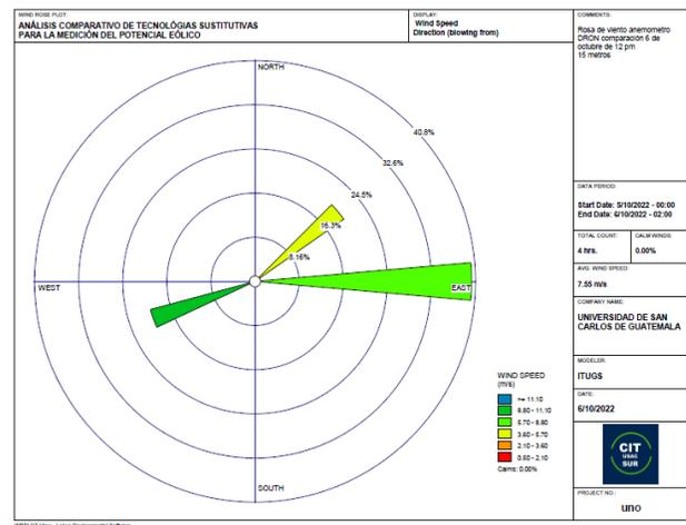
Rosas de viento producto de los datos obtenidos con el anemómetro instalado en el mástil (izquierda) y el anemómetro elevado con el uso del dron (derecha); fecha y hora, 6 de octubre de 2022 a las 11:00 hrs, se considera la misma dirección del viento dada la cercanía entre los dos instrumentos durante la medición, imágenes obtenidas con el empleo de WRPLOT VIEW 8.0.2.
