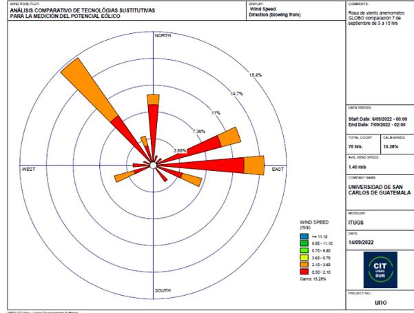
Rosas de viento producto de los datos obtenidos con el anemómetro instalado en el mástil (izquierda) y el anemómetro elevado con el uso de globos inflados con helio (derecha); fecha y hora, 7 de septiembre de 2022 de 10:00 a 15:00 hrs, se considera la misma dirección del viento dada la cercanía entre los dos instrumentos durante la medición, imágenes obtenidas con el empleo de WRPLOT VIEW 8.0.2.
