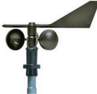
Nota: el anemómetro de cazoletas es el instrumento más común para la medición de la velocidad del viento en estudios eólicos. Tomada de (Boveri, A. B., & ABB, S. 2012).
