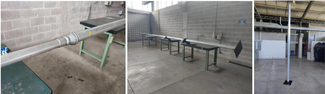
Nota: a la izquierda, detalle del reductor tipo campana, al centro, ensamble de los tubos, acoples y base del mástil, a la derecha prueba de equilibrio de la base y tubos roscados. Elaboración propia.
