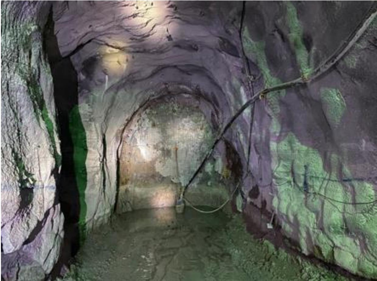
**Figura 38. Bombeo del agua subterránea en los túneles de explotación**
