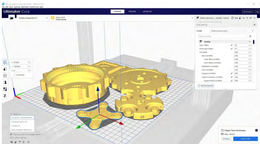
Figura 55. Configuración de parámetros para impresión 3D en PLA.
