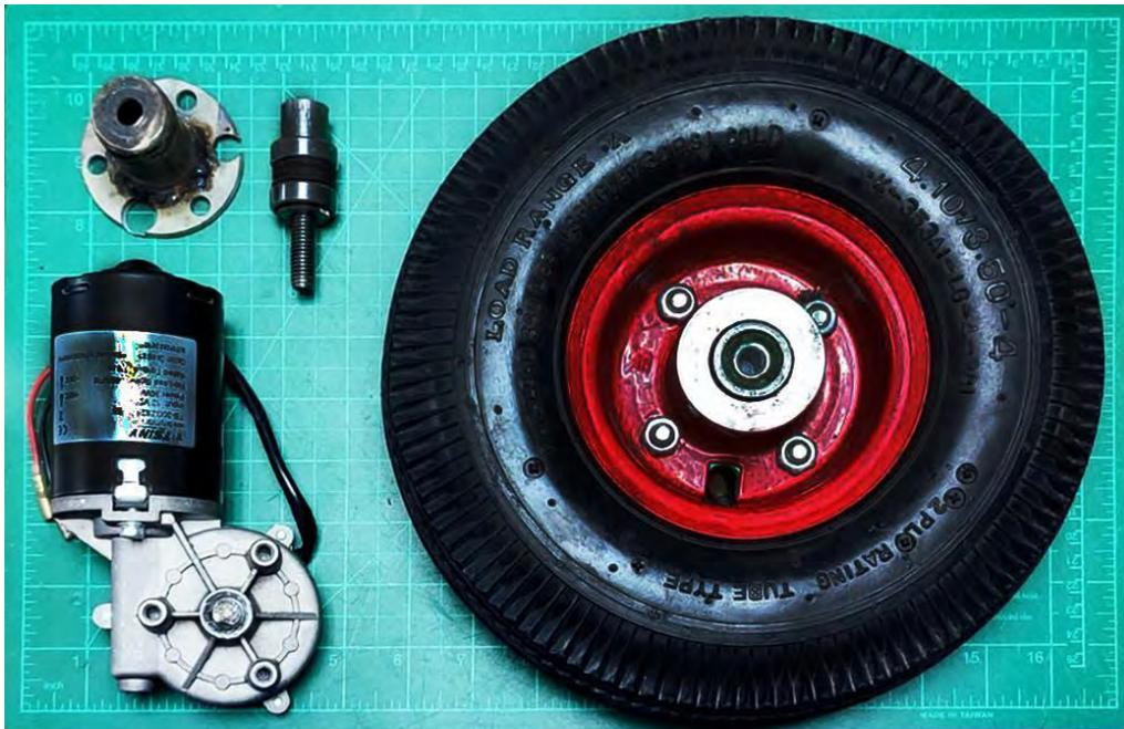
*Figura 4. Componentes de sistema motriz de robot móvil.*
