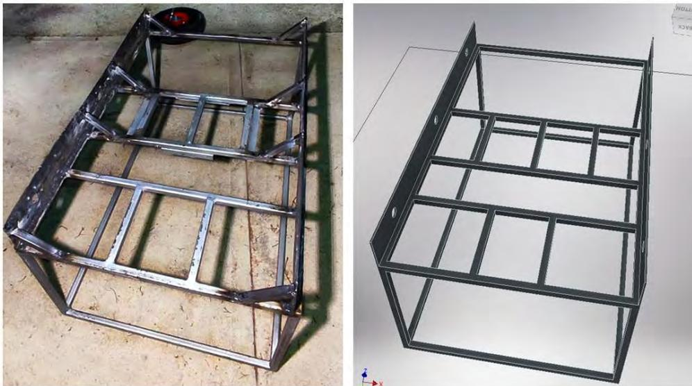
*Figura 3. Diseño en software de chasis de robot móvil.*
