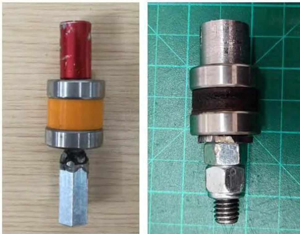
*Figura 5. Acople de llantas a motor en sistema matriz.*
