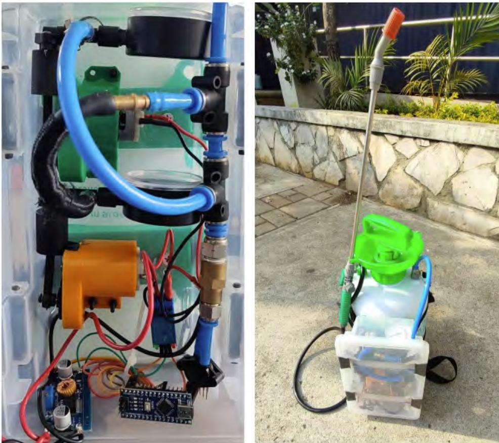
*Figura 37. Desarrollo de sistema de riego con ajuste de presión automática.*
