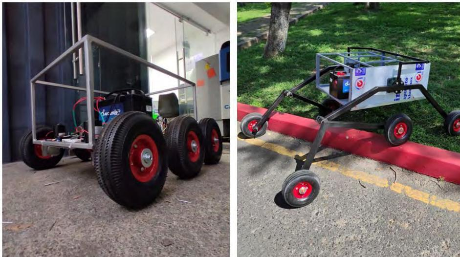
*Figura 46. Desarrollo de mecanismos para robot móvil.*
