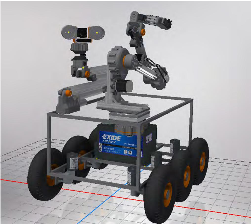
*Figura 53. Simulación mecánica de robot móvil con brazos ensamblados.*
