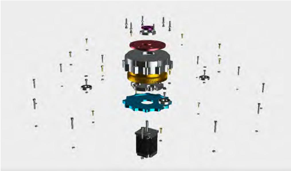
*Figura 52. Desacople mecánico de reductor armónico.*
