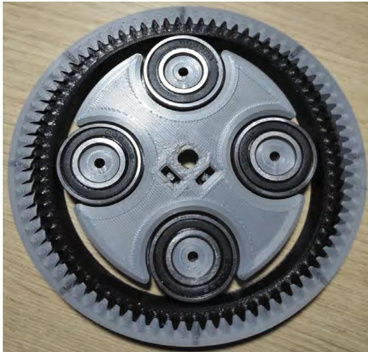
*Figura 20. Desarrollo de engranajes helicoidales para reductor armónico en impresión 3D sólida y flexible.*
