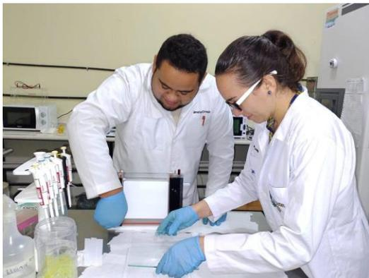
Armado de la cámara vertical
