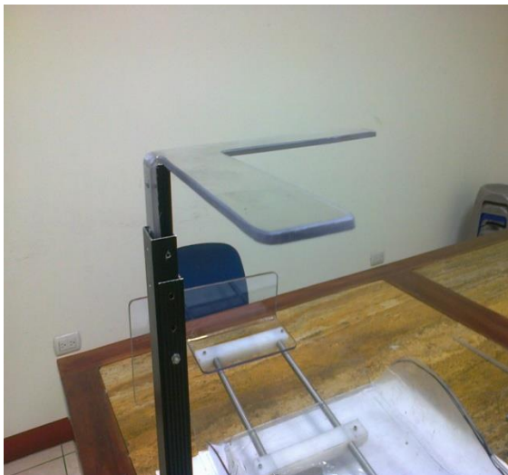
Brazo extensible con accesorio de tope para medir al niño de pie y base
