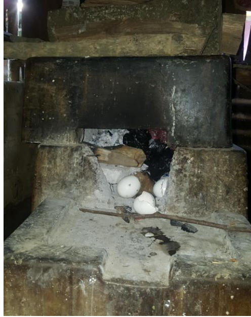
Figura 10 Estufa con atizadero reducido, denominada estufa mejorada 1 en esta investigación.
