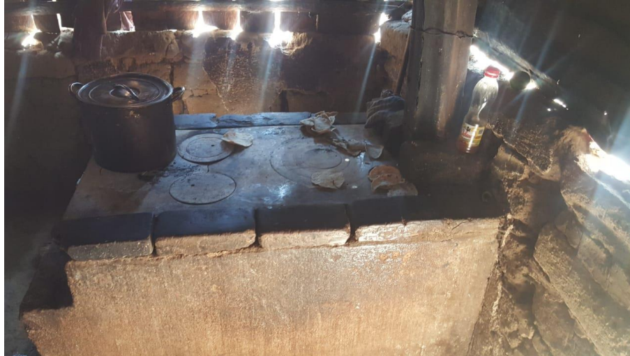
Figura 7 Estufa mejorada existente, se aprecia el tamaño reducido, falta de espacio para ollas que no se desean a fuego directo y chimenea de lámina de metal. Este es el modelo que se denominó estufa mejorada 2 (Tratamiento 2)
