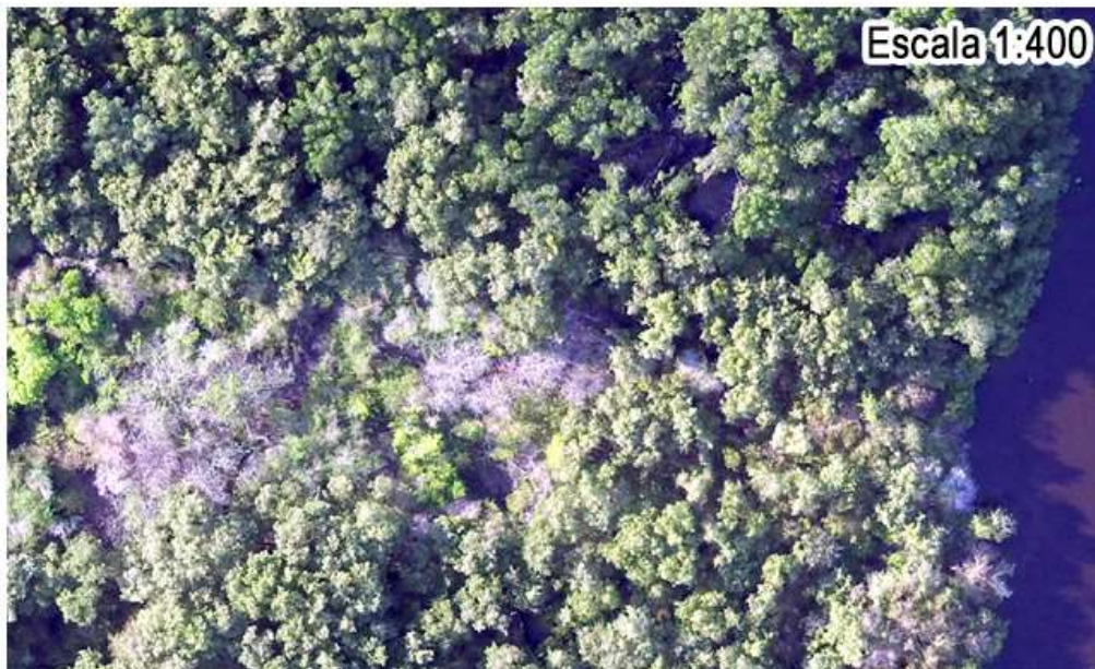
Figura 5. Calidad espacial de los mosaicos obtenidos con el vehículo aéreo no tripulado Phantom 3 Advanced. El tamaño de unidad mínima de los mosaicos tiene un promedio de aproximadamente 9 centímetros.
