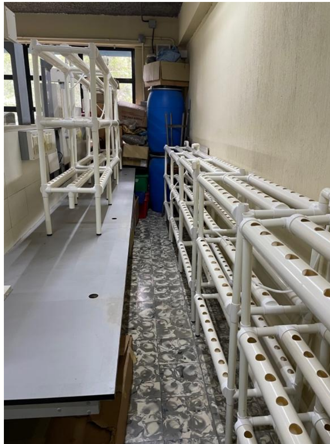
Figura 7. Ensamblaje y montaje de sistemas hidropónicos en el área designada.
