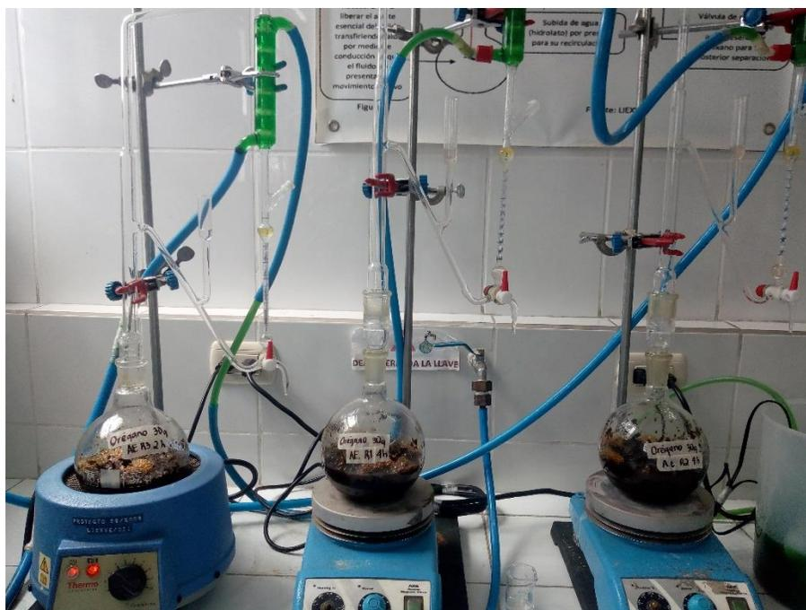
Figura 28. Obtención del aceite esencial de orégano a escala laboratorio
