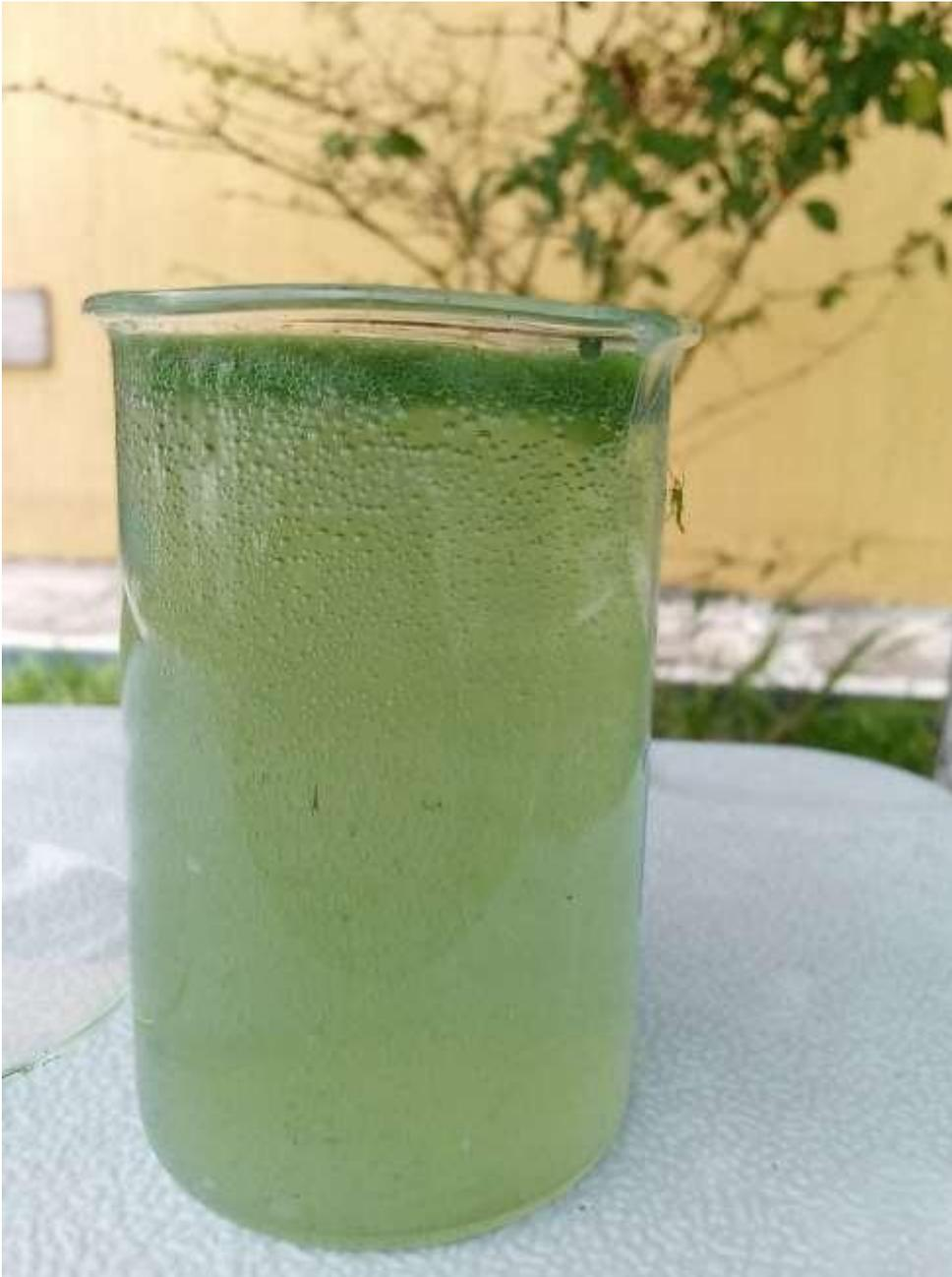
*Fotografía 19. Apariencia del agua proveniente de la pileta, del Lago de Amatitlán con 8 horas de tratamiento con nanoburbuja de oxígeno al dejar reposar por dos horas.*
