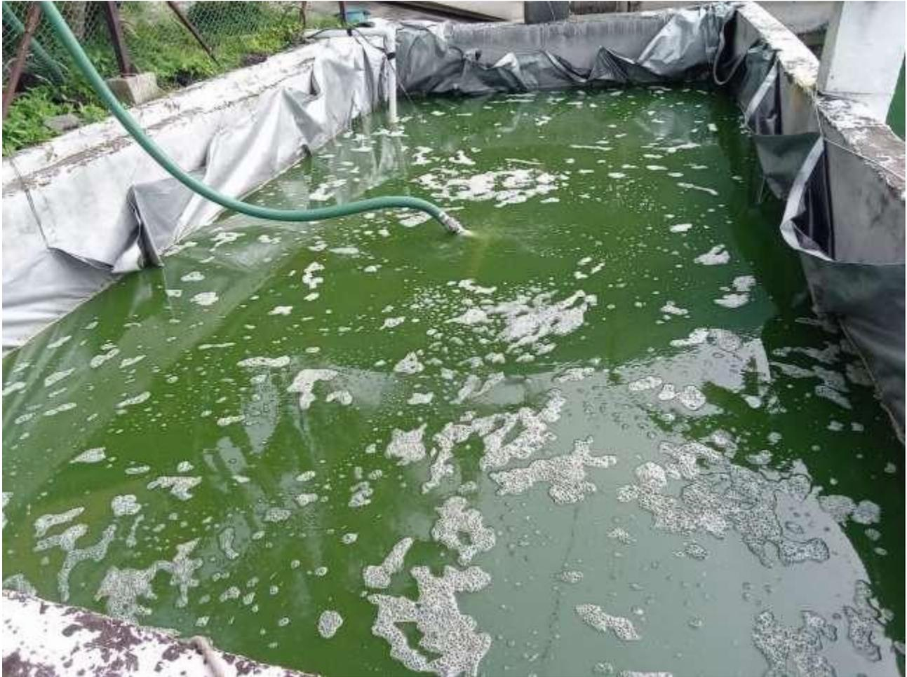
*Fotografía 12. Pileta con agua del Lago de Amatitlán donde se observa abundante espuma después de 10 horas de tratamiento con Nanoburbuja de oxígeno.*
