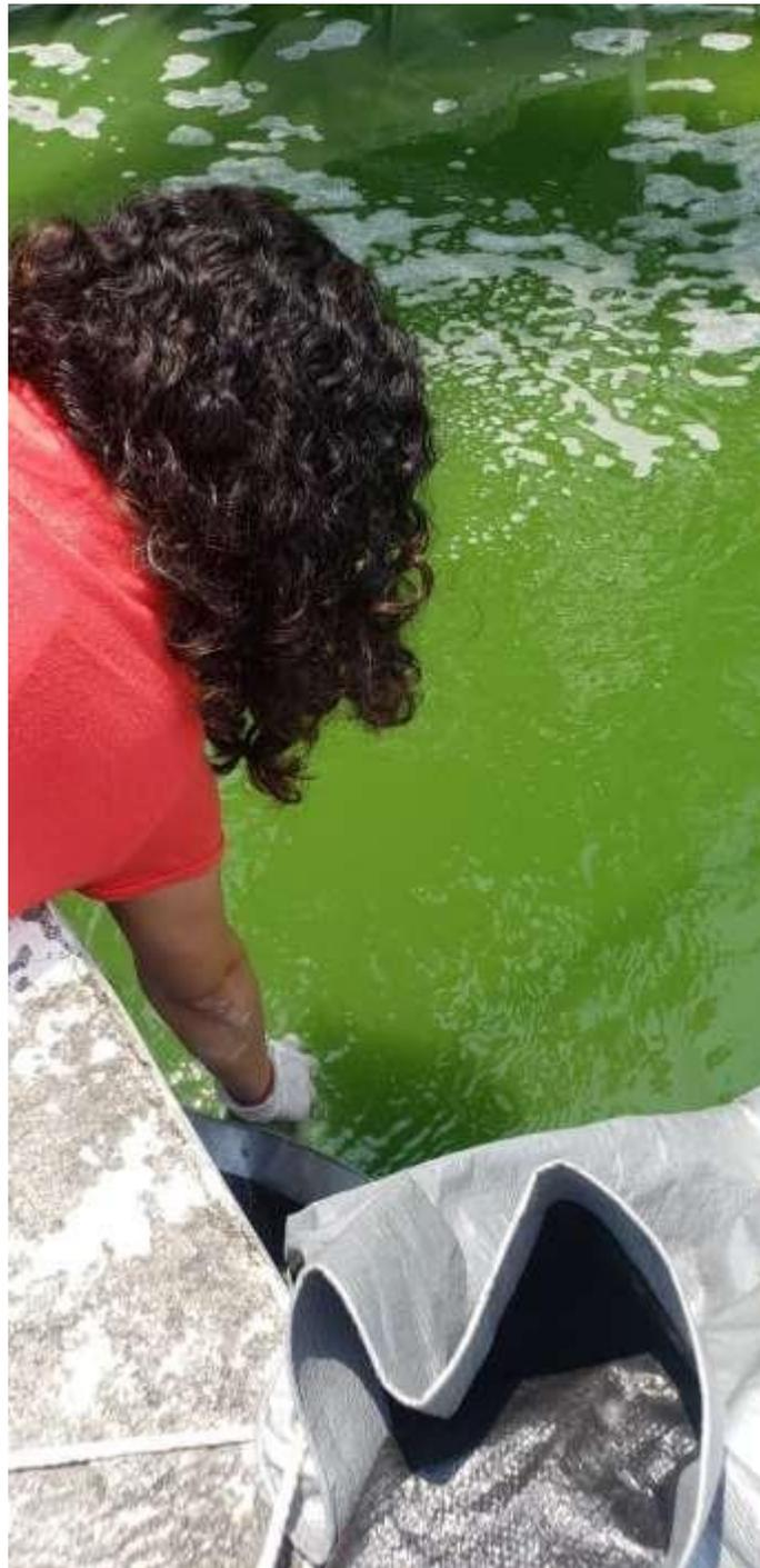
*Fotografía 14. Toma de muestra para análisis microscópico Mónica Martínez 8 horas posterior al tratamiento con nanoburbujas de oxígeno.*
