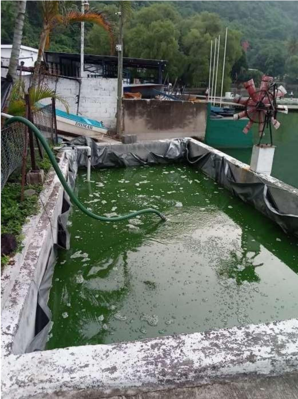
*Fotografía 11. Pileta con agua del Lago de Amatitlán donde se observa espuma por el tratamiento de Nanoburbuja de oxígeno después de 6 horas de tratamiento.*
