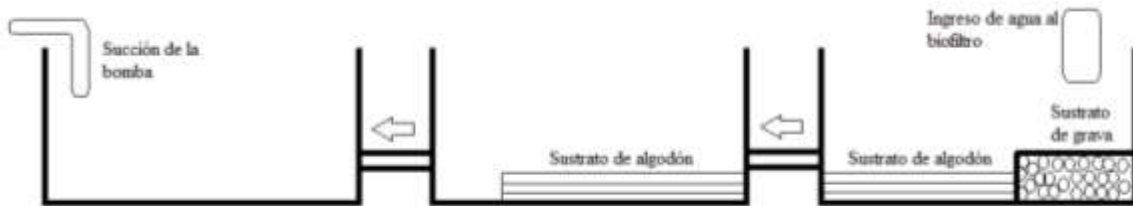
Figura 5. Esquema del biofiltro utilizado en el sistema de recirculación de agua para
