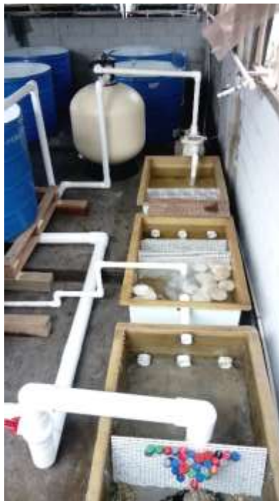
Apéndice 3. Biofiltro diseñado para la remoción de los componentes del nitrógeno.
