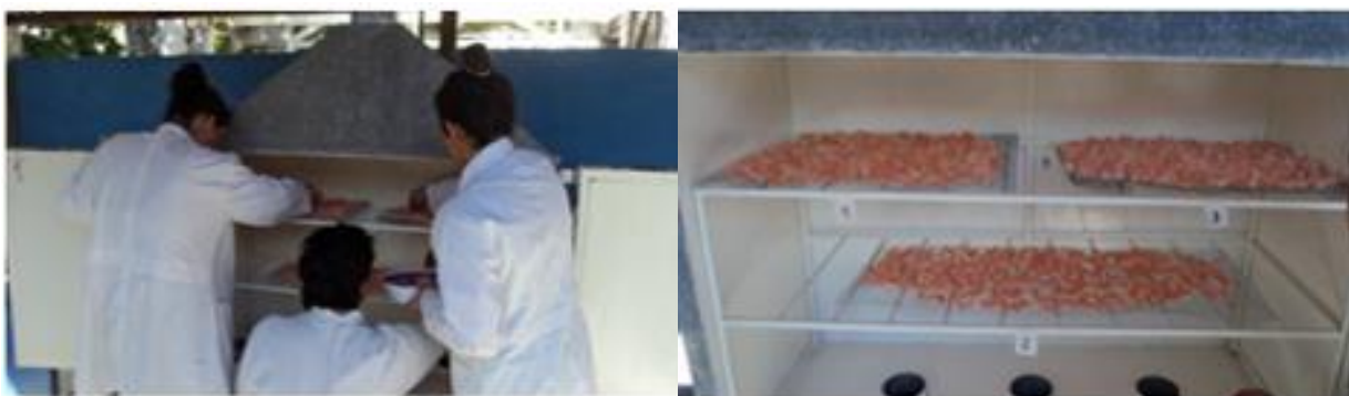
Anexos 40 y 41. Colocación del camarón en horno de convección alimentado por energía solar térmica.
