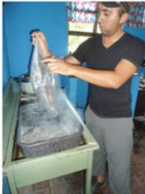
Anexos 18, 19 y 20. Lavado, peso inicial y tratamiento térmico a 90°.
