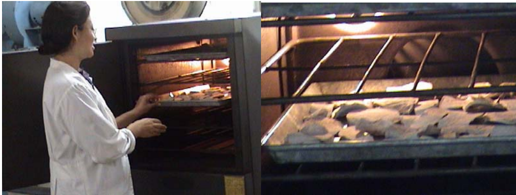
Figura 10 Deshidratado de malanga en horno de convección forzada
