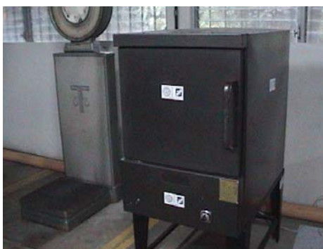
Figura 7. Horno deshidratador. Planta Piloto CUNSUROC.
