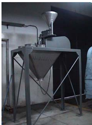
Figura 8. Molino de cuchillas en la planta piloto del CUNSUROC.
