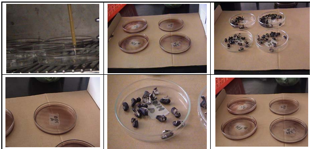
Figura 14. Proceso de trabajo para realizar las pruebas de porcentaje de humedad en el frijol. Fuente: Proyecto Frijol de vara, (2004).
