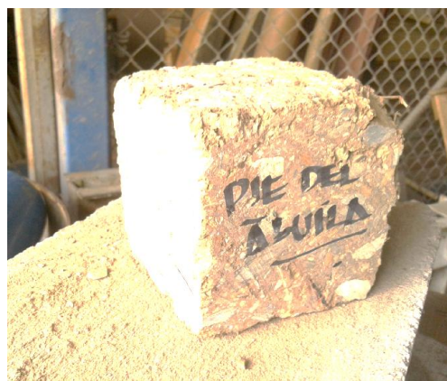
Figura 1: Labrado de cubos de 10cm x 10cm x10cm de adobe. Figura 2: Resultado del labrado de cubos de 10cm x 10cm x10cm a partir de un adobe entero
