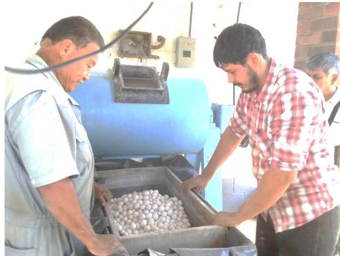
Figura 10: Molino de bolas marca Patterson en funcionamiento, en una de las molindas del material puzolánico de Sacapulas. Figura 11: Descarga del molino de bolas marca Patterson
