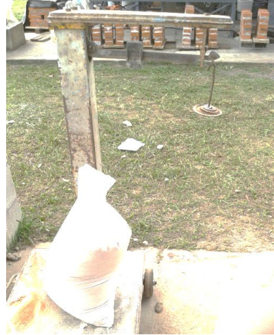
Figura 8: Secado de material puzolánico, de un banco ubicado en Sacapulas, Quiché Figura 9: El material aparentemente puzolánico siendo pesado en la balanza
