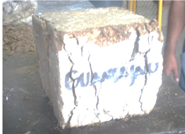
Figura 3: Ensayo a compresión de cubo de adobe de Guantajau en la Máquina a Universal Hamilton. CII T-5 Figura 4: Cubo de adobe fallado por compresión proveniente de Guantajau. Grietas perpendiculares a la cara donde se aplicó la carga.
