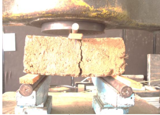
Figura 5: Cubo de adobe fallado por compresión proveniente de Pie del Águila. Nótese la colocación de áridos en los adobes, esto demostró mejorar la resistencia a pruebas de compresión. Figura 6: Adobe ensayado a flexión en la Máquina Universal Hamilton proveniente de Guantajau. La falla se presenta en una grieta que ya existía en el adobe antes de ser ensayado, se presume se formó al momento de la contracción de la arcilla durante el proceso de secado. Llamó la atención del equipo el que el adobe no cayera luego de la falla, al ser sacado se examinó el interior y se llegó a la conclusión de que fue debido a unas ramas de pino que tenía en el eje neutro. Si en la construcción de adobes se pusiera más cuidado al momento de la fabricación, debería ponerse mayor énfasis en incluir ramas de pino en el eje neutro del elemento.
