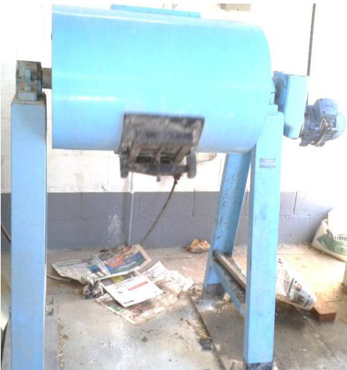
Figura 10: Molino de bolas marca Patterson en funcionamiento, en una de las molindas del material puzolánico de Sacapulas. Figura 11: Descarga del molino de bolas marca Patterson
