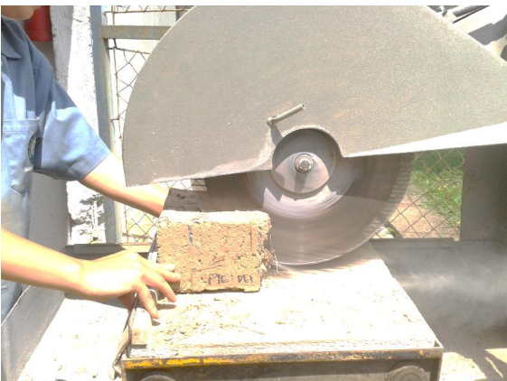
Figura 1: Labrado de cubos de 10cm x 10cm x10cm de adobe. Figura 2: Resultado del labrado de cubos de 10cm x 10cm x10cm a partir de un adobe entero
